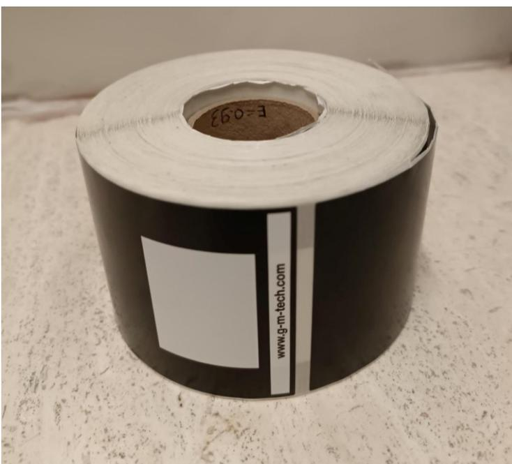
Figura 4 Nastro ad emissività nota [www.g-m-tech.com].
