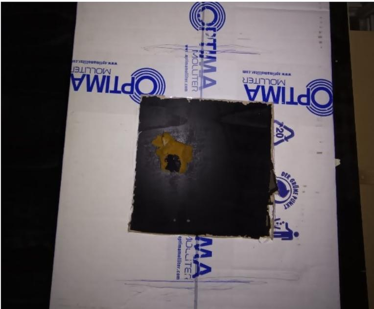
*Figura 12 Inserimento dello schermo nella camera di riscaldamento dopo lo spegnimento delle lampade.*
