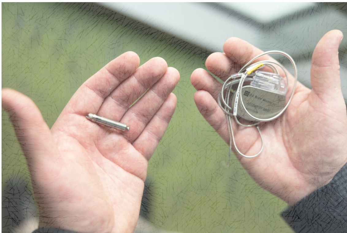
Figura 1: Un pacemaker tradizionale (destra) confrontato con un pacemaker leadless (sinistra). (Photo by Andrew Davis Tucker/UGA)
