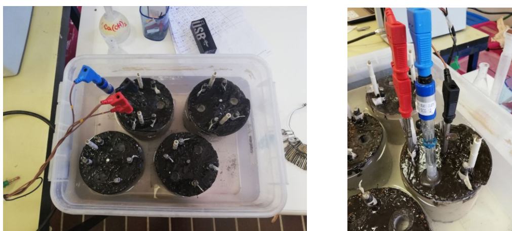
Fig. 61 Esempio di prova di corrosione in bagnato
