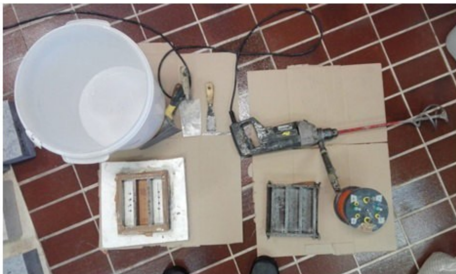
Fig. 18 Attrezzatura utilizzata per l'esecuzione dei gatti.
