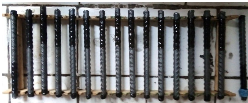
Fig. 16 Barre di armatura ( \varnothing = 8 mm) resinate.
