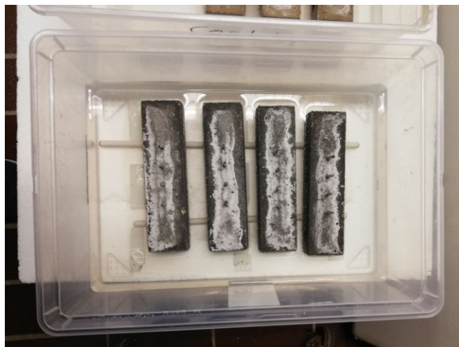
Fig. 56 Provini utilizzati per l'impedenza elettrica immersi in soluzione 3,5% NaCl
