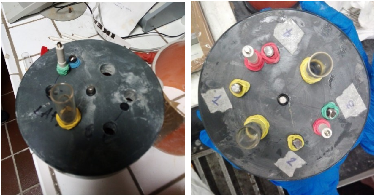
Fig. 15 Assemblaggio delle barre di armatura, degli elettrodi di riferimento e dei controelettrodi al coperchio superiore del campione cilindrico.
