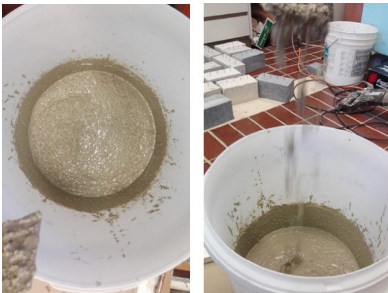
Fig. 19 Lavorabilità della malta di riferimento dopo l'aggiunta del superfluidificante.
