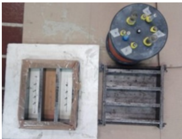
Fig. 20 Casseforme utilizzate per il getto delle malte.
