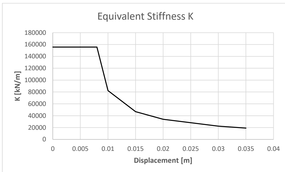
Fig 4.11 Rigidezza equivalente del sistema reticolare al variare dello spostamento massimo imposto - sezione di appoggio
