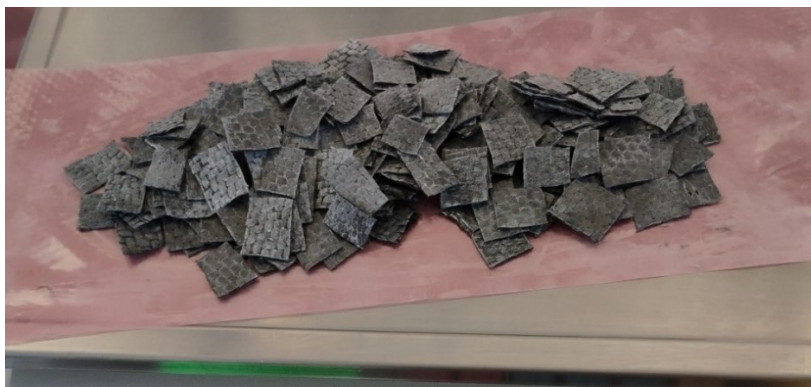
Fig. 1 - Ritagli di prepreg con tessitura twill utilizzati nella tesi
