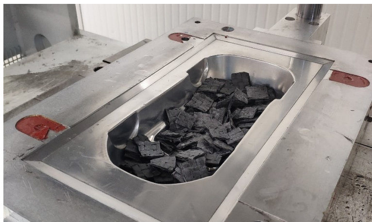
Fig. 38 - Inserimento nello stampo di chips con grammatura di 1250\text{g/m}^2
