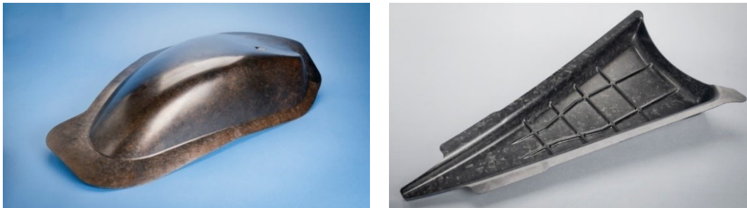
Fig. 12 - Componenti automotive prodotte per compression molding
