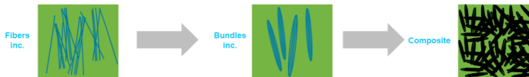
Fig. 73 - Decomposizione del composito in bundles in Digimat-MF
