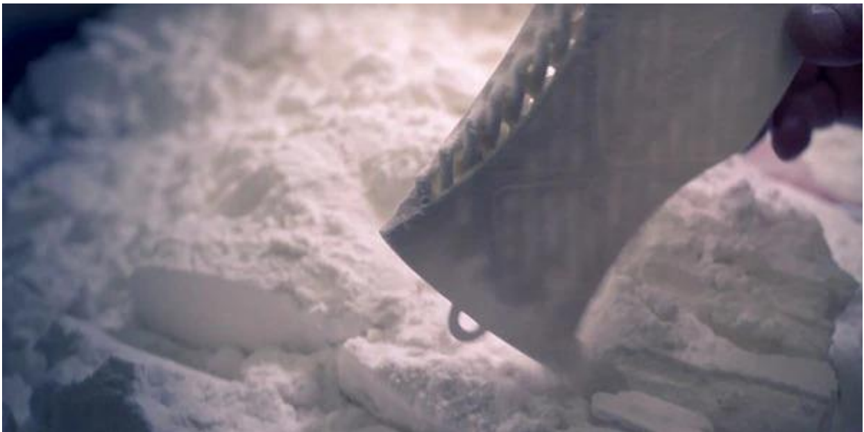
Figura 2.7-Un pezzo, realizzato con tecnica Powder Bed e al cui interno possiamo vedere un'intricata struttura, viene estratto dal letto di polvere
