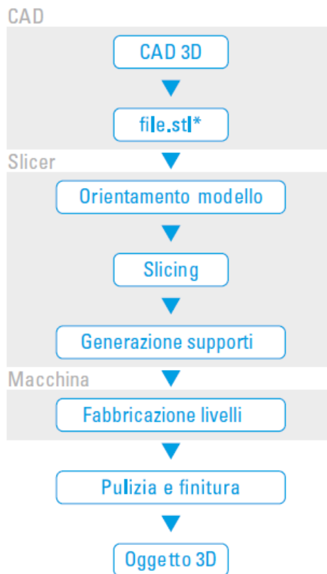
Figura 2.2-Workflow del processo produttivo additive
