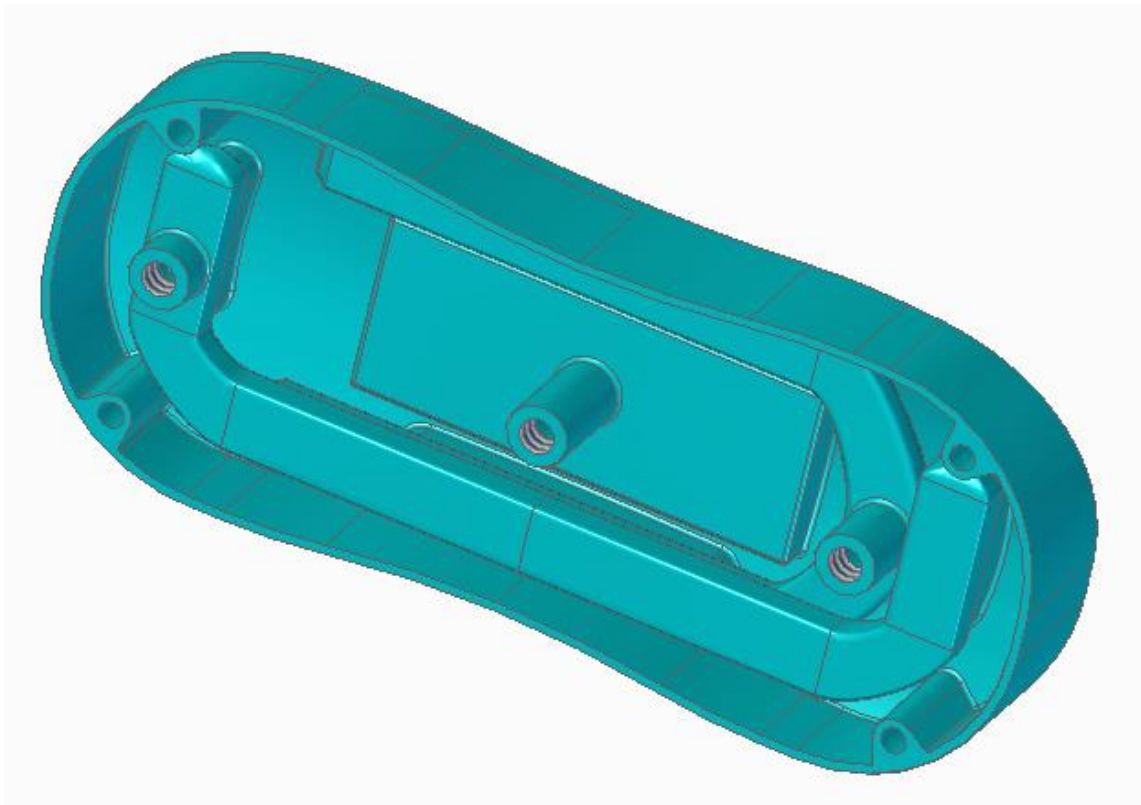
Figura 3.34-L'aggiunta delle pareti laterali e delle colonnine si associa alla presenza dei rispettivi smussi ai sottosquadri
