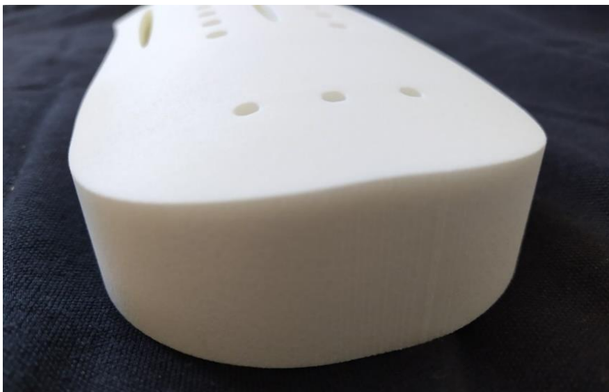
Figura 4.15-Dettaglio di una zona ad alta ruvidità
