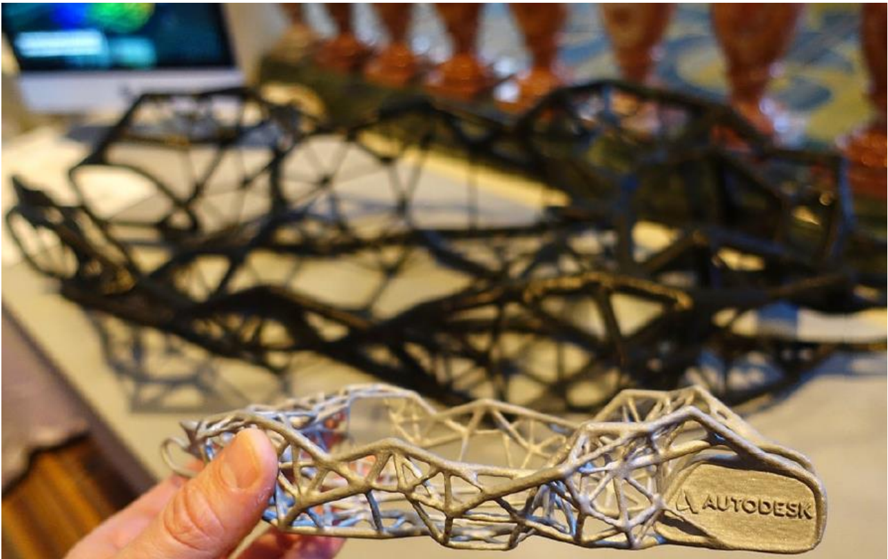
Figura 2.25-Esempio di una struttura reticolare realizzata con una stampante 3D
