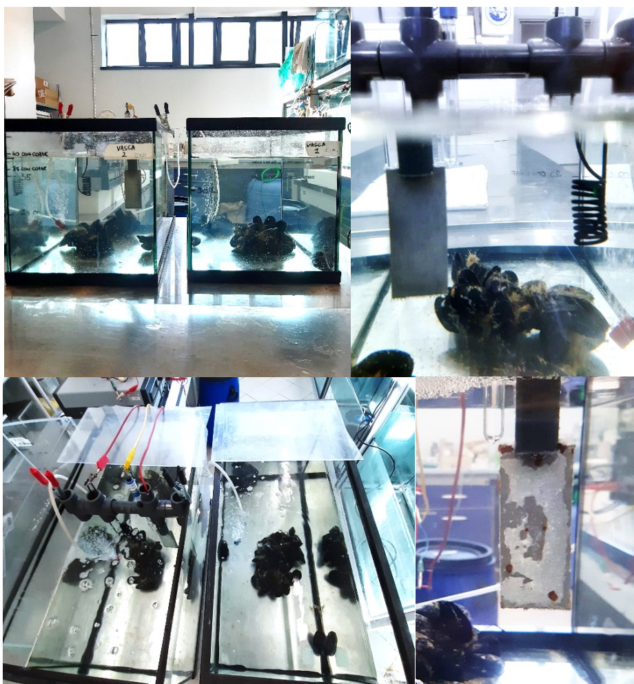
Figura 4: setting sperimentale. In alto a sinistra: le due vasche sperimentali; in alto a destra: vasca sperimentale “esposto” in cui è presente la cella elettrochimica. In basso a sinistra: confronto tra le due vasche; in basso a destra: catodo con accrescimento minerale adeso nella vasca “esposto”.
