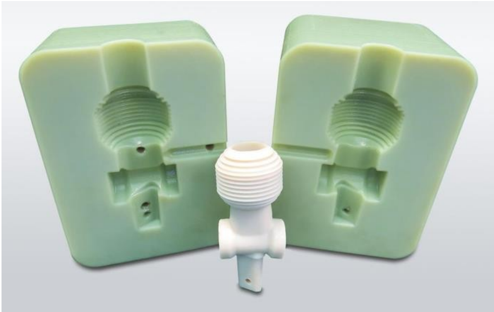
Figura 3-4 pezzi ottenuti dallo stampaggio ad iniezione
