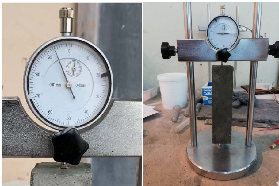
Figura 21. Misurazione del ritiro assiale.
