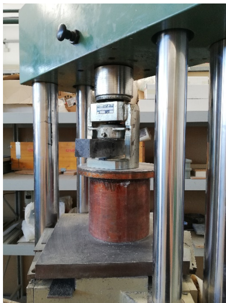
Figura 23. Prova compressione provini 40x40x160 mm.
