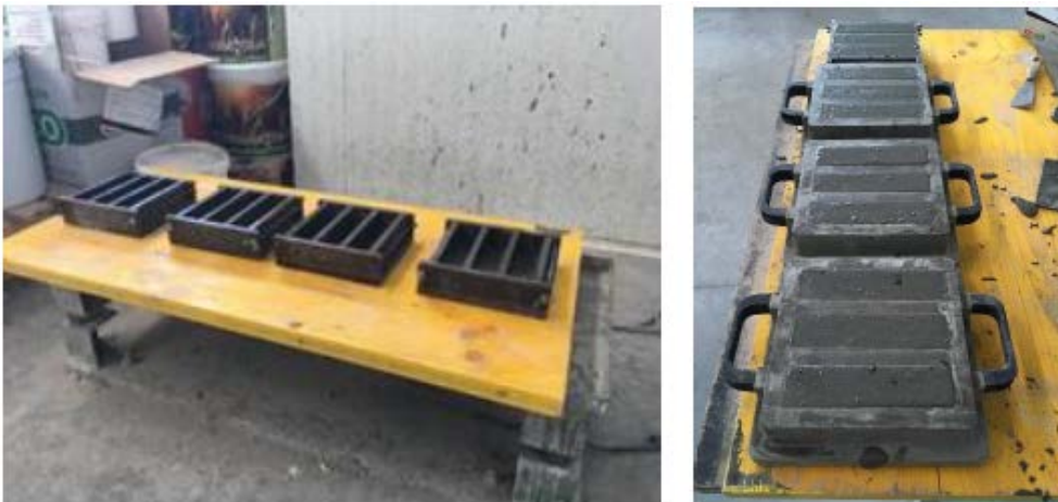
Figura 19. Getto e vibrazione della miscela.
