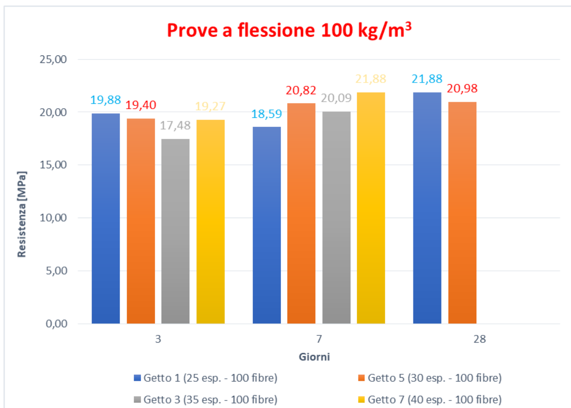
Figura 29. Risultati prove a flessione miscele 1, 3, 5, 7.
