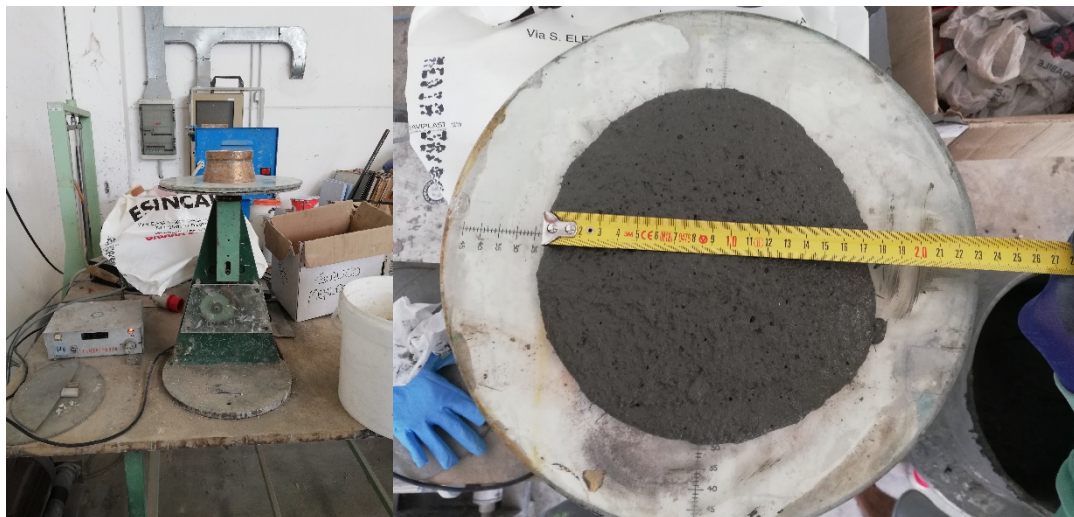
Figura 20. Strumento per la misurazione dello spandimento.
