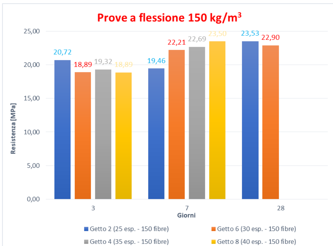
Figura 30. Risultati prove a flessione miscela 2, 4, 6, 8.
