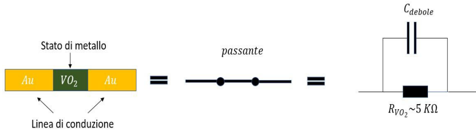
Figura 4.5 - Operazioni generali di uno switch basato su VO_2 e il relativo circuito equivalente allo stato ON.
