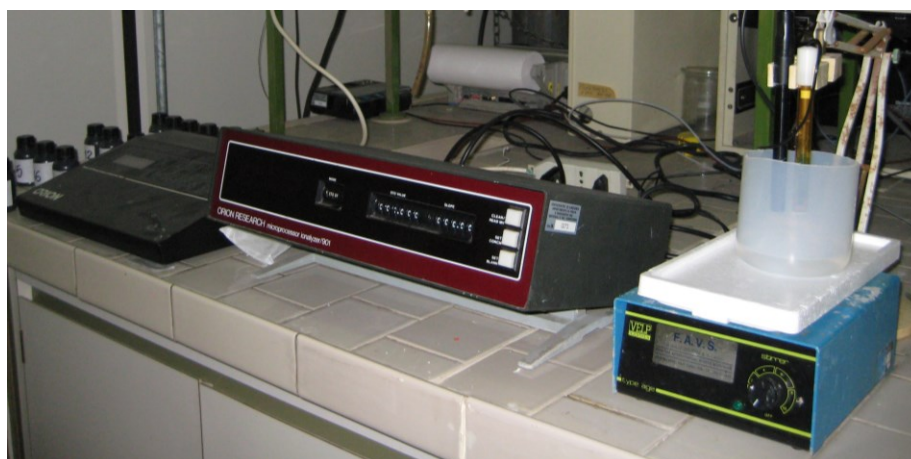
Fig.20 - Strumentazione utilizzata in laboratorio per l'analisi con elettrodo iono-selettivo.
