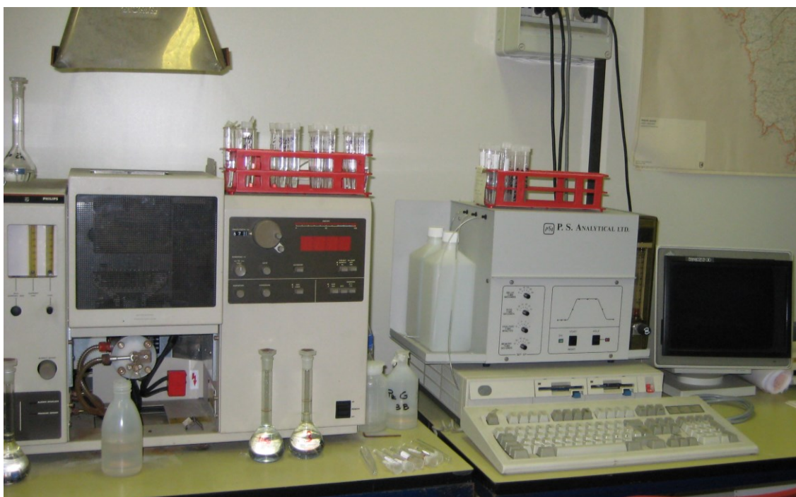
Fig.22 – Spettrofotometro ad assorbimento atomico utilizzato per l'analisi in laboratorio
