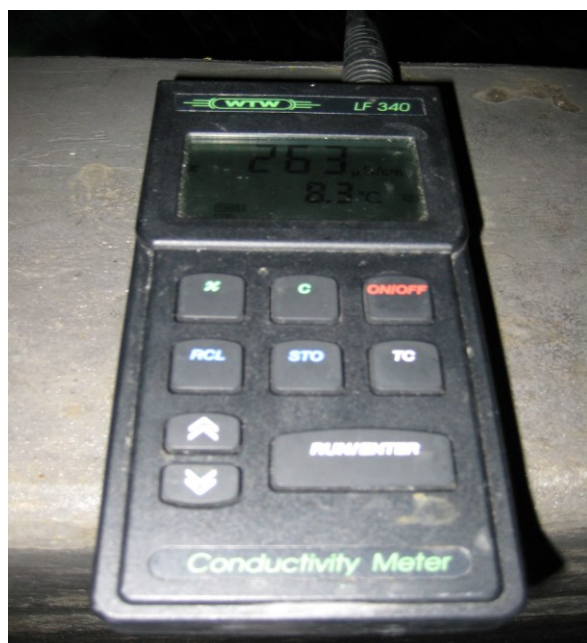
Fig. 28 – Strumento per il rilevamento di conducibilità e temperatura
