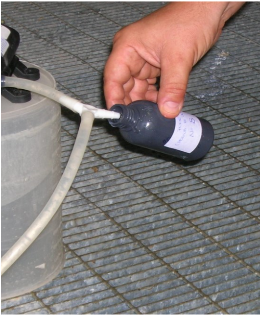
Fig.10 - Particolare del riempimento delle bottigliette permesso da una piccola ramificazione del tubicino da cui fuoriusciva acqua
