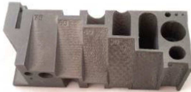
Figura 2.3 Finitura delle superfici in Downfacing in un range di angoli compresi tra 75° e 90°.
