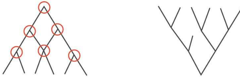
Figura 2.11 Formazione di linee di ritiro con orientazione convergente (sinistra) e prevenzione di linee di ritiro con orientazione divergente (destra).
