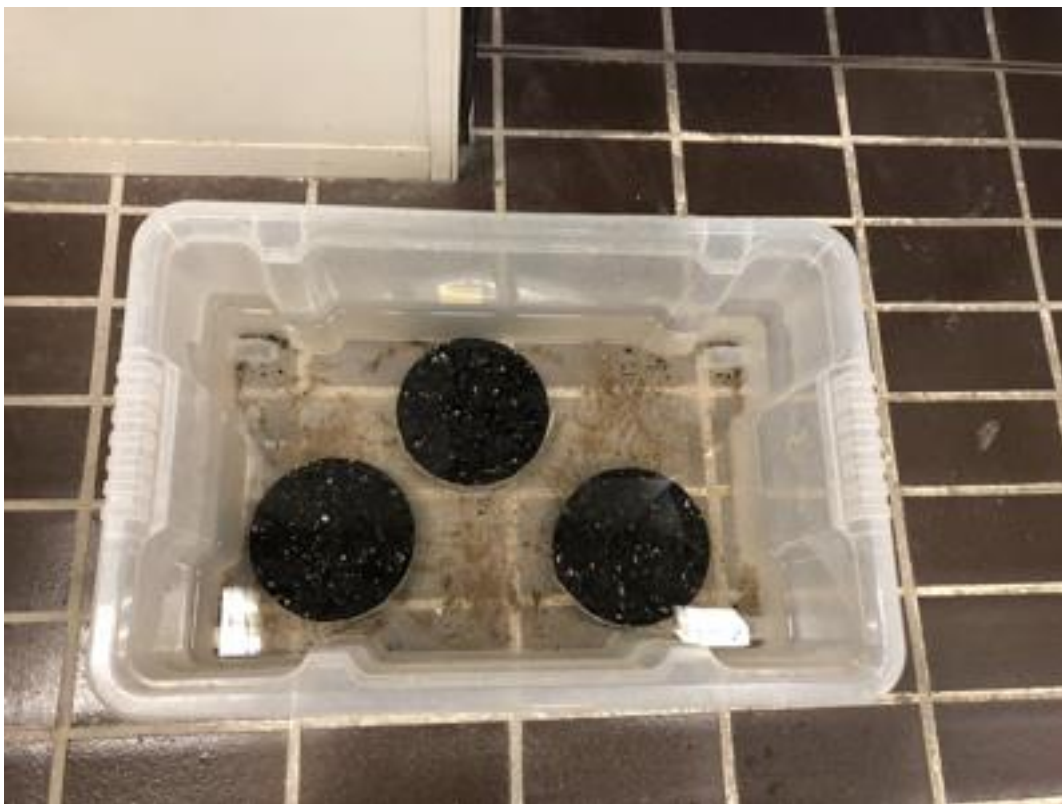
Figura 4.9: Provini in una bacinella d'acqua
