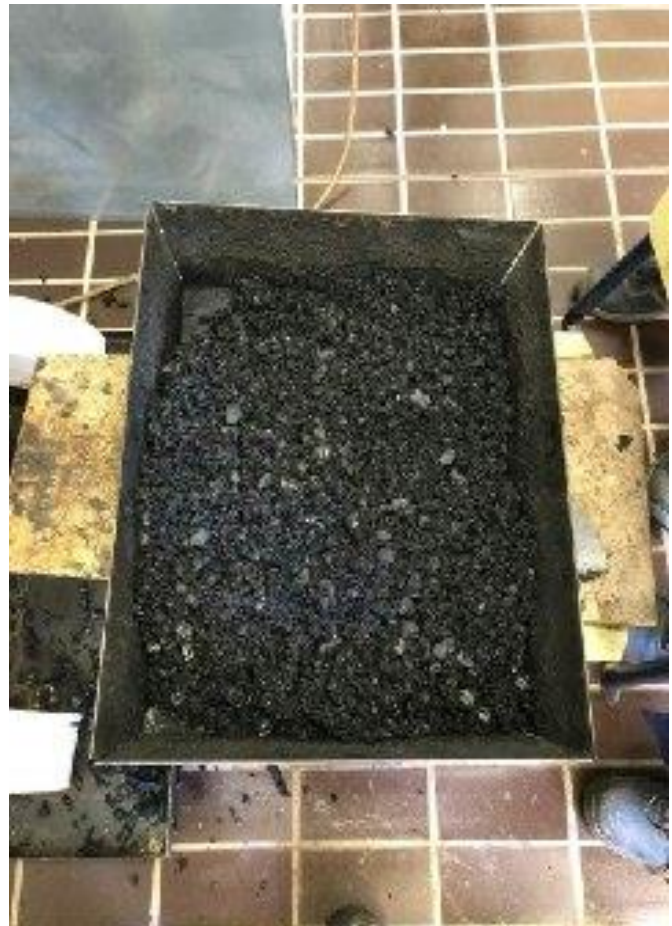
Figura 4.3: conglomerato bituminoso nelle teglie
