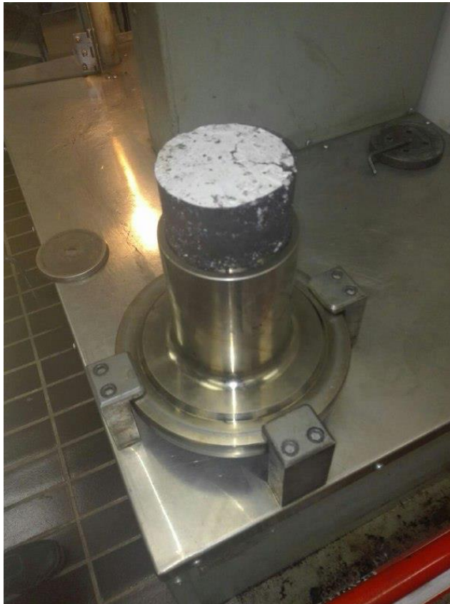
Figura 3.26: estrazione del provino dalla fustella
