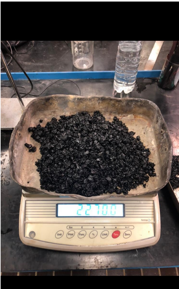
Figura 4.3: conglomerato bituminoso nelle teglie
