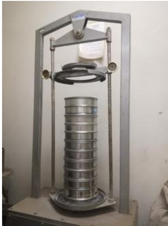
Figura 3.4: pila di setacci inseriti nella macchina vibrante
