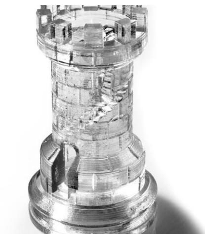
Fig. III. 5 Resina sinterizzata tramite SLA
