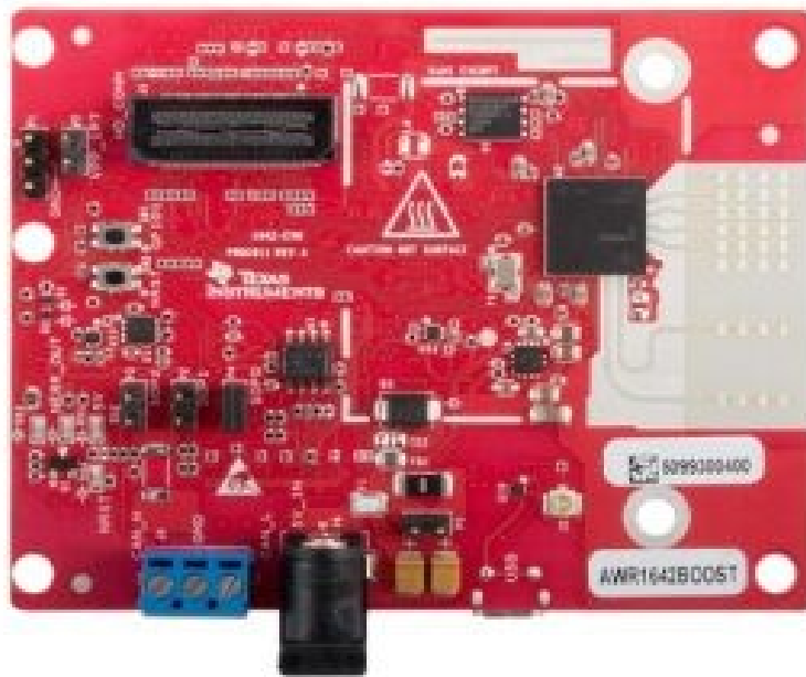
Figura 2.1. Scheda AWR1642BOOST per radar automotive TI AWR1642
