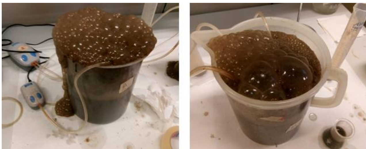
Figura 23: Formazione di schiume sui campioni di fango A (sinistra) e fango B (destra)
