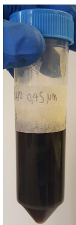
Figura 14: Campione filtrato del fango in uscita dalla termoidrolisi
