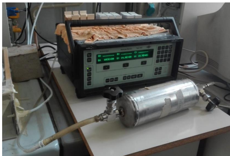
Figura 8: Analisi del campione di biogas introdotto nella bombola tramite gas-cromatografo
