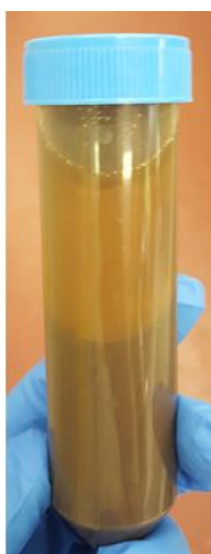
Figura 12: Fango separato in uscita dalla termoidrolisi
