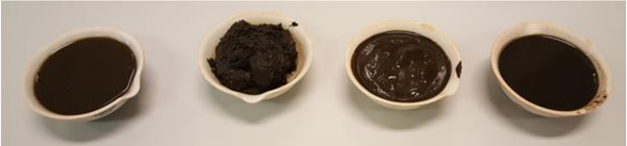
Figura 9: Campioni per la misura del contenuto di solidi, da sinistra: A, B, C, D
