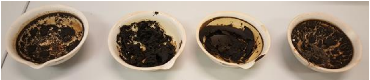
Figura 10: Campioni essiccati a 105 °C, da sinistra: A, B, C, D
