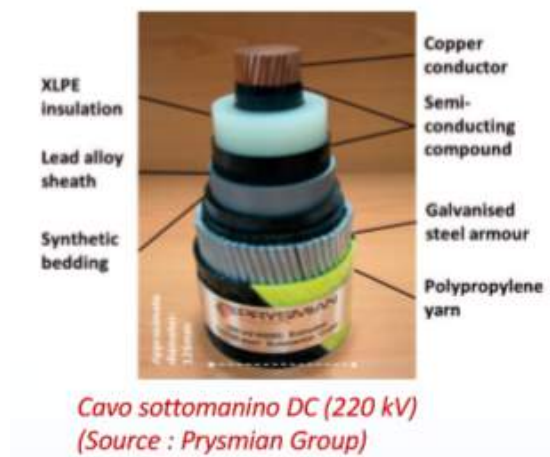
Figura 1.54: cavo per la trasmissione in corrente continua prodotto da Prysmian Group [47]
