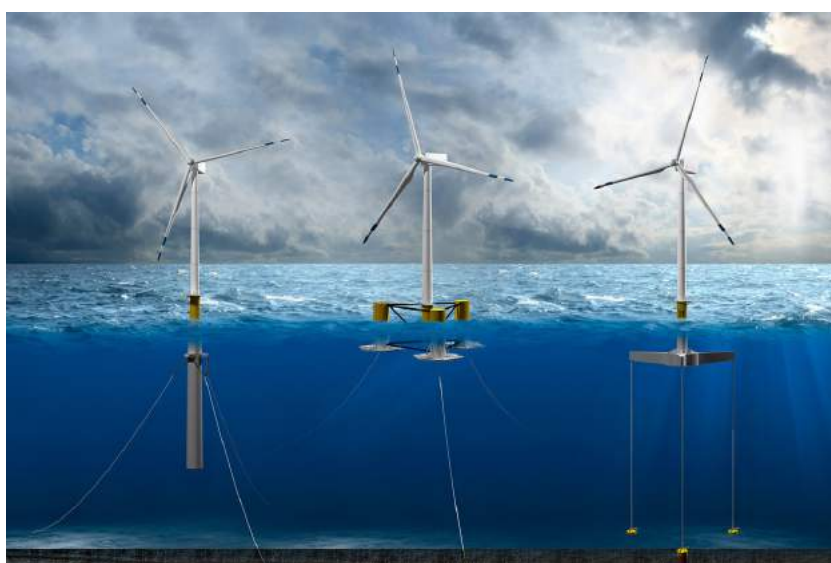
Figura 1.20: Soluzioni galleggianti: spar, struttura semi-sommersa e TLP [26]
