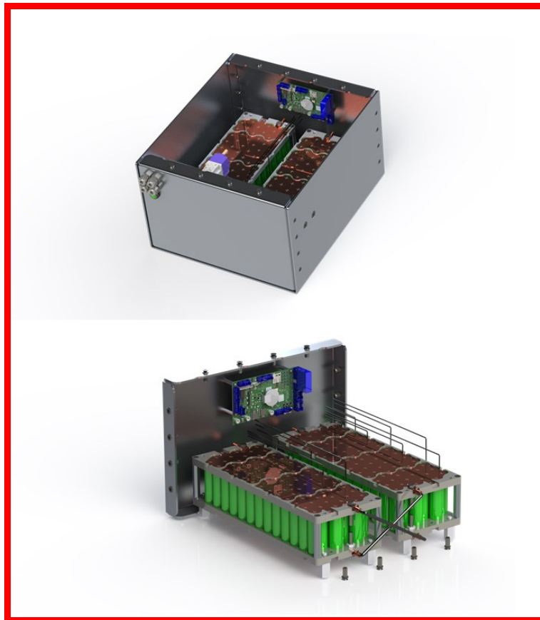
Figura 4.14: Render della Batteria 13S12P
