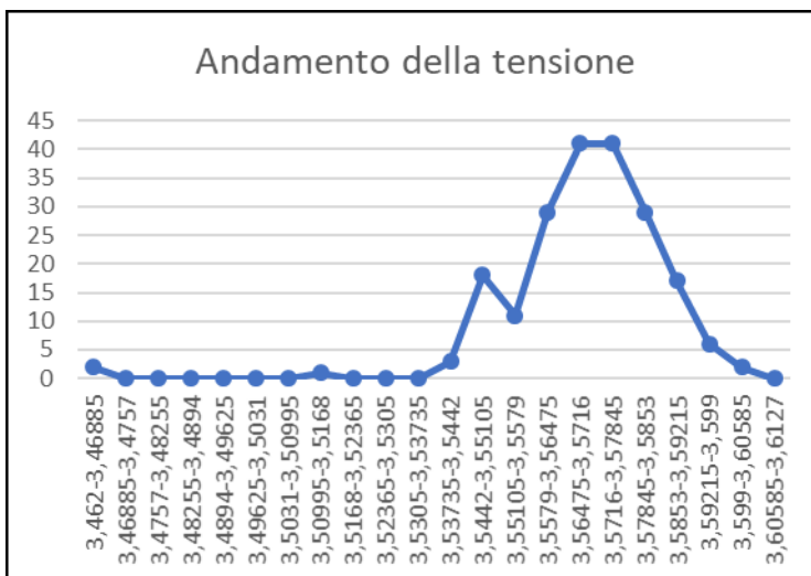
Figura 2.5: Grafico tensione celle VS n° celle
