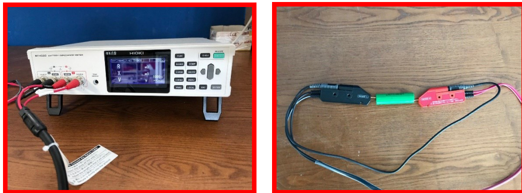
Figura 2.4: Misuratore di impedenza HIOKI BT 4560
