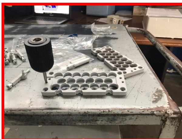
Figura 5.2: Piastre di sostegno delle celle della batteria
