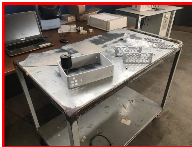
Figura 5.1: Case e piastre di sostegno delle celle della batteria
