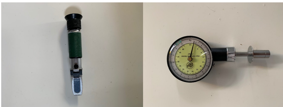
Figura 3.6. Refrattometro a sinistra, penetrometro a destra
