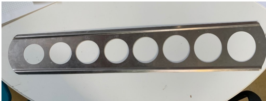
Figura 3.5. Calibro a stecca utilizzato per la suddivisione in classi.
