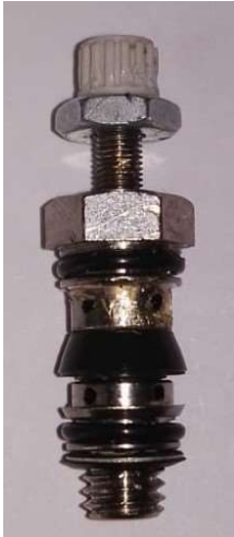
Figura 20: Struttura interna del rubinetto
