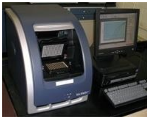
Figura n° 10 Stratagene: Strumento per la Real-time PCR sia qualitativa sia quantitativa.
