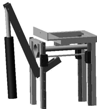
Figura 5.25 – Meccanismo definitivo con pattini e guide
