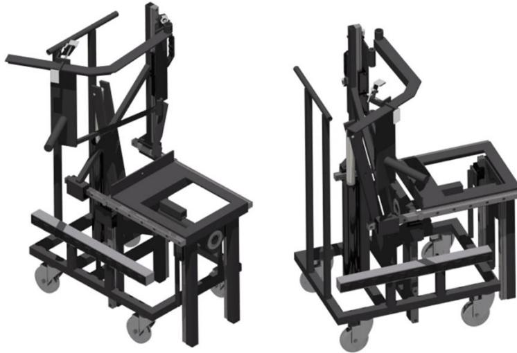
Figura 5.37 - Rendering LCA con il sistema di presa serbatoio chiuso
