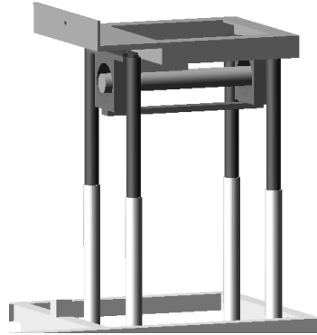
Figura 5.24 - Primo meccanismo di salita e discesa con dei tubi
