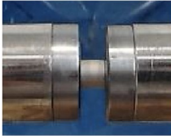
Fig. 4.45: Provino posizionato tra le due barre (Input e Output Bar).
