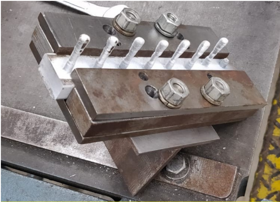
Fig. 4.11: Sistema di afferraggio dei provini dotati del substrato.
