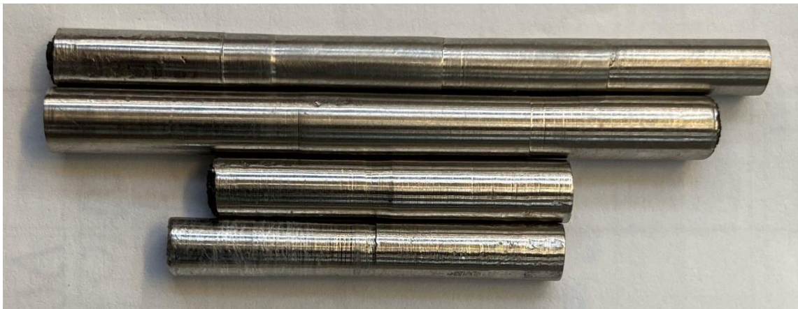
Fig. 3.19: Cilindri in superlega di nichel IN625 ottenuti dopo l'operazione di tornitura.
