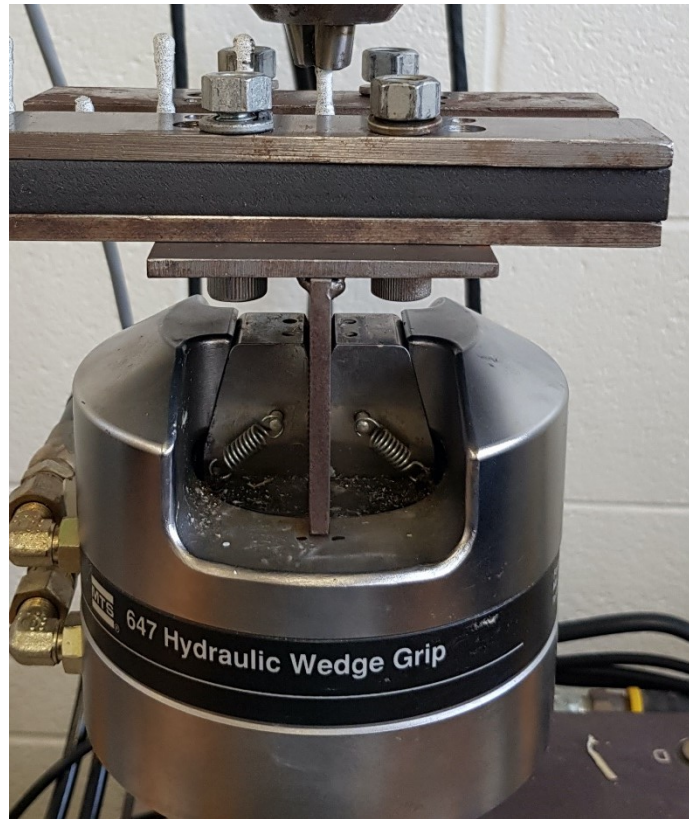
Fig. 4.13: Set-Up del sistema di afferraggio e del provino per i test di trazione.
