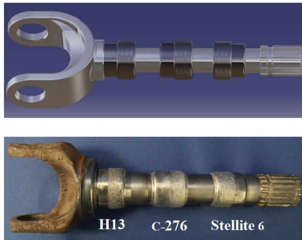
Fig. 1.10: Giunto meccanico realizzato con tre differenti materiali mediante LMD. [16].
