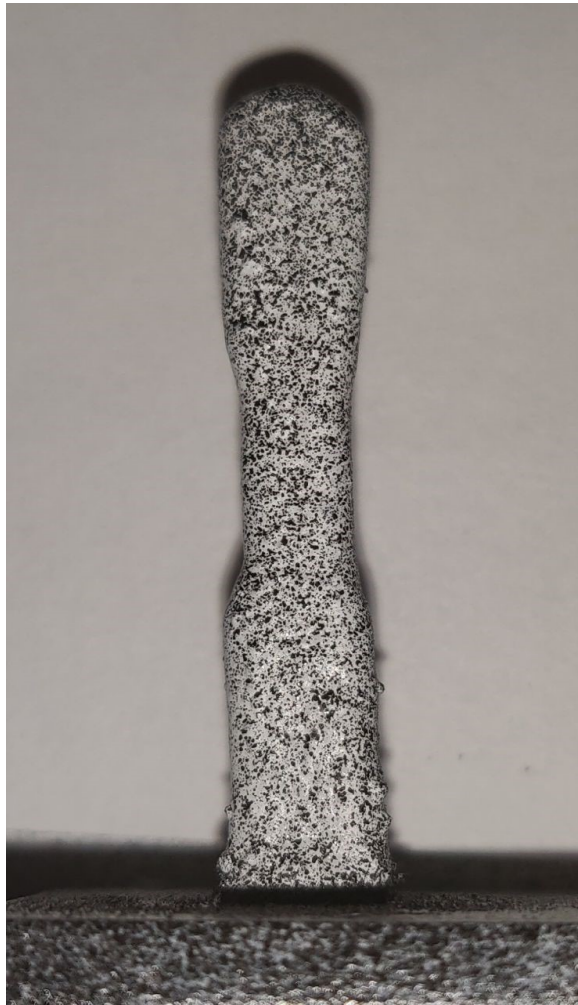
Fig. 4.15: Provino flat su cui è stato realizzato lo speckle.
