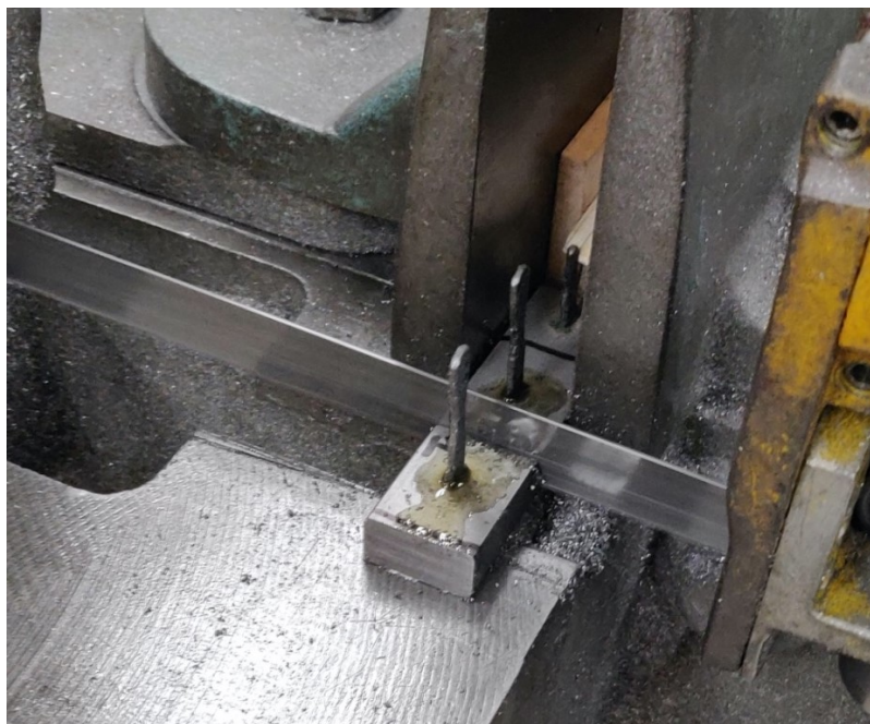
Fig. 3.7: Rappresentazione del taglio del substrato mediante segatrice a nastro (provini flat).
