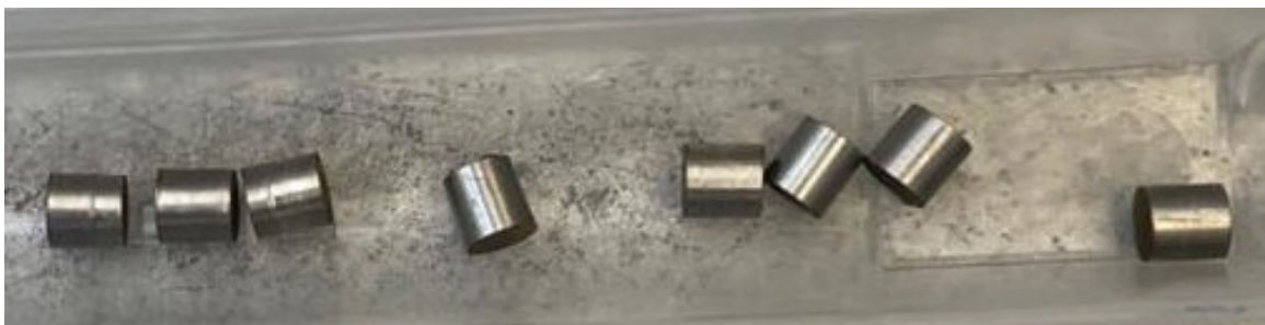
Fig. 3.20: Provini cilindrici ottenuti con taglio per elettroerosione.
