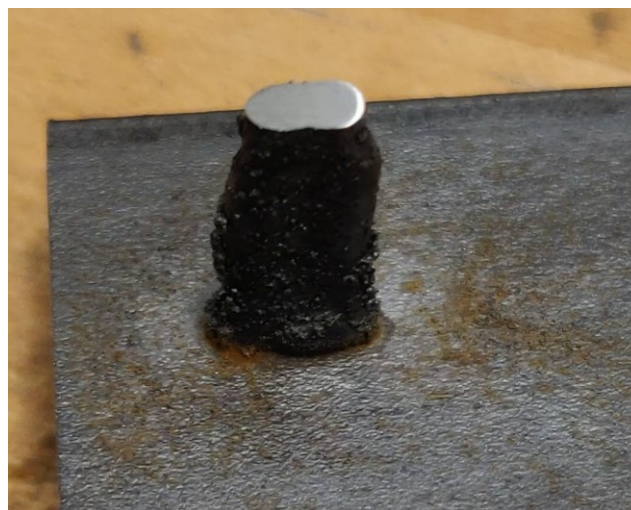
Fig. 5.1: Provino Flat tagliato trasversalmente (piano XY).
