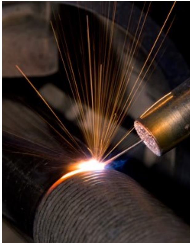
Fig. 1.11: Applicazione della tecnica LMD con il processo di Laser Wire Cladding. [16].
