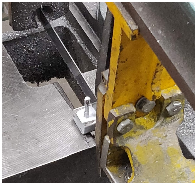
Fig. 3.11: Rappresentazione del taglio del substrato mediante segatrice a nastro (provini cilindrici).
