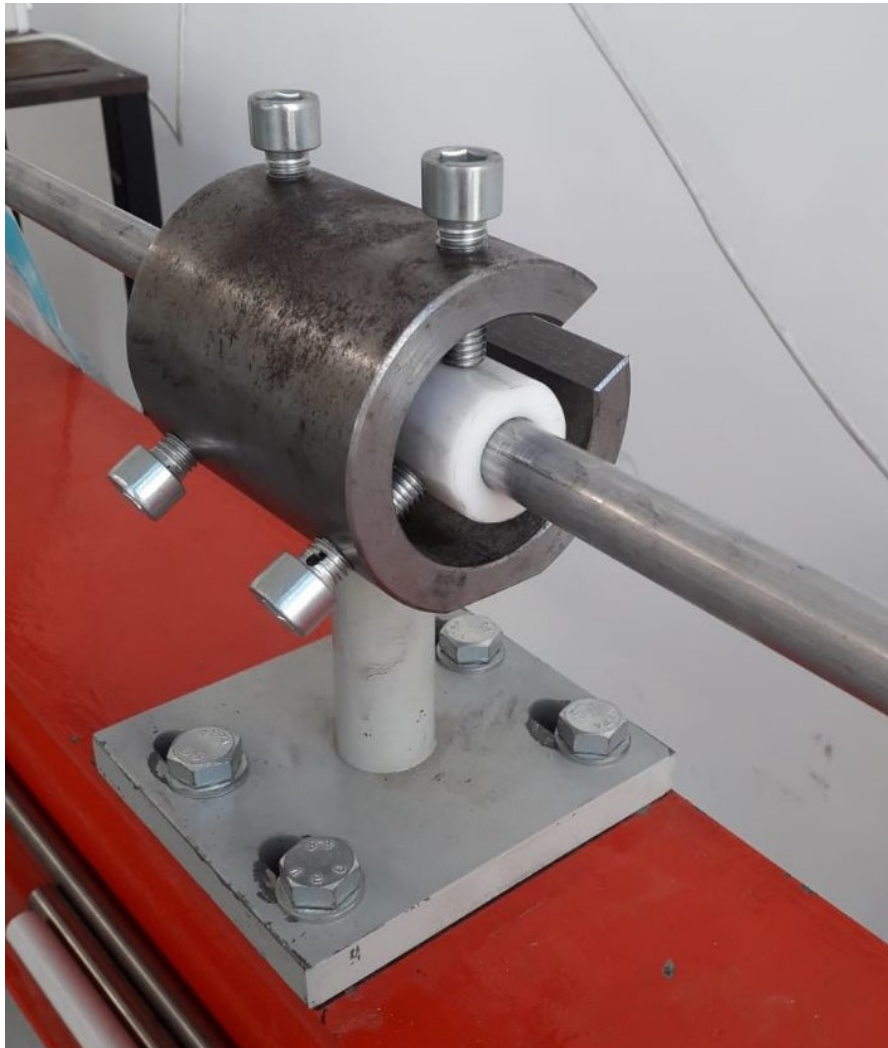
Fig. 4.41. Supporto in acciaio dotato di elemento in materiale polimerico.
