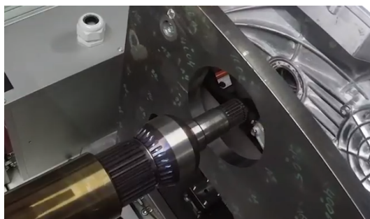
Figura 2.7: Albero millerighe della trasmissione lenta in fase di approccio.
