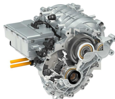
(b) Asse elettrico con spaccato della trasmissione.
