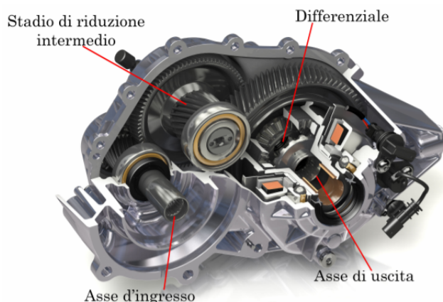
Figura 2.5: La "gearbox": asse di ingresso, unità di riduzione, differenziale e asse di uscita.
