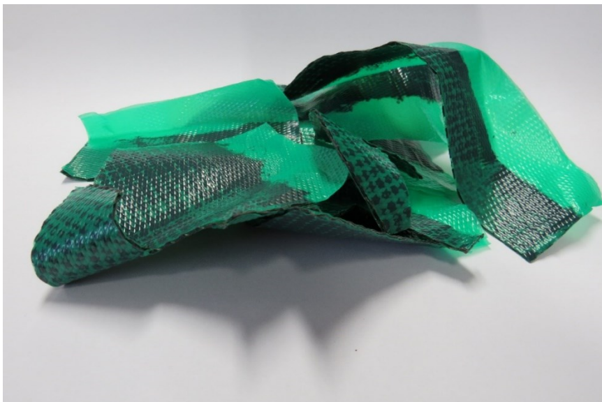
Fig. 3.2 – Esempio di sfrido derivante dalle operazioni di taglio effettuate da HP
