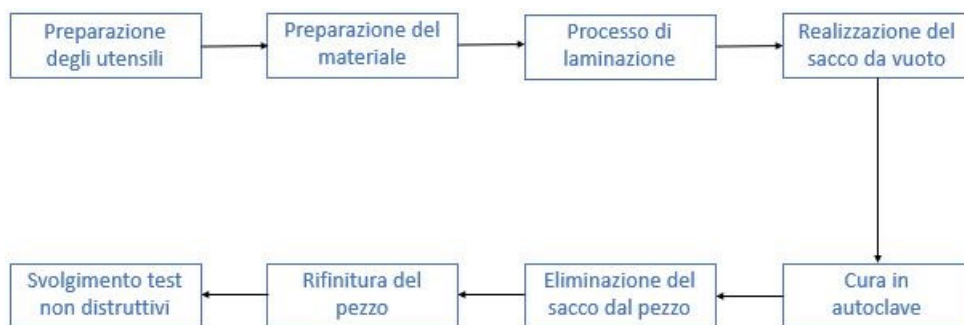
Figura 1.35: Step di processo del Bag Molding.
