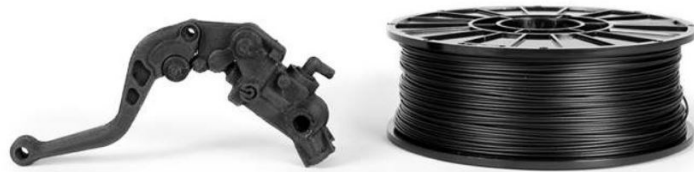
Figura 1.55: A sinistra un prodotto realizzato tramite Carbon PA; a destra il filamento.
