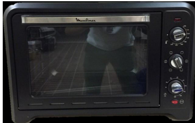
Figura 2.15: Forno utilizzato per l'eliminazione dell'umidità nella bobina.
