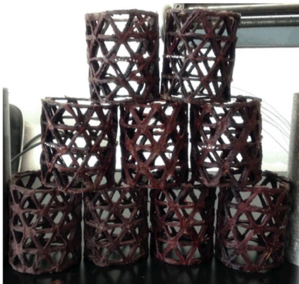
Figura 1.48: Isogrid circolari realizzati mediante Filament Winding [8].
