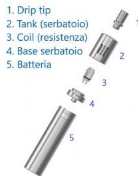
Fig.6: struttura delle e-cig.
