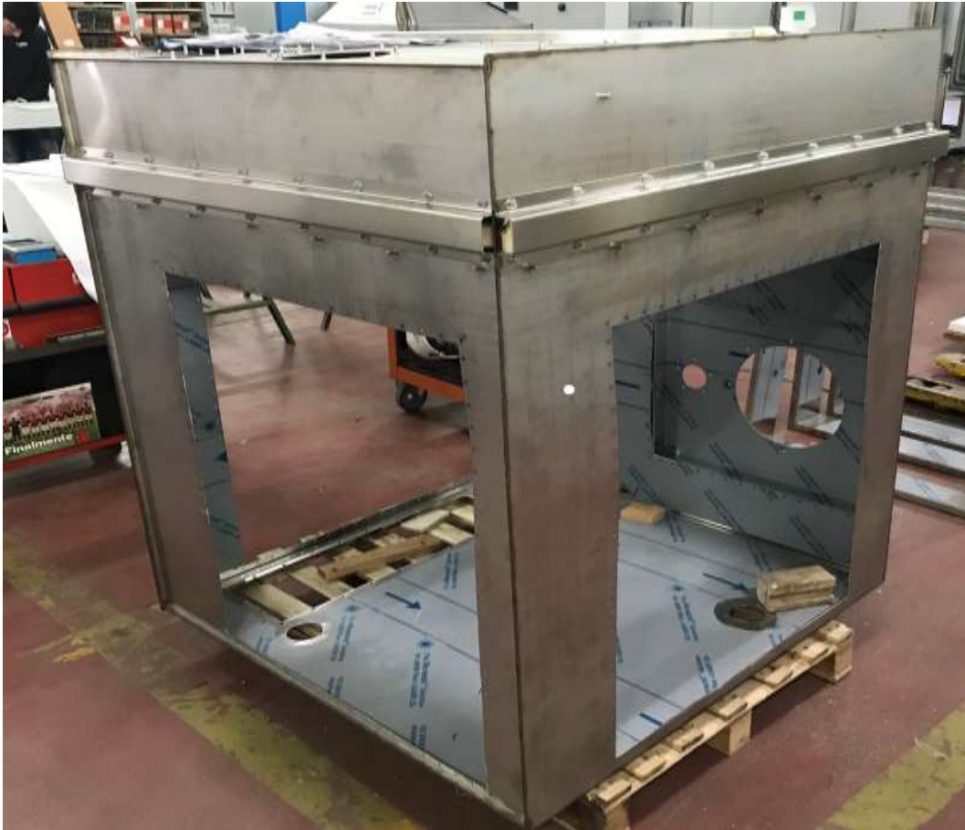
Figura 3 struttura interna camera climatica
