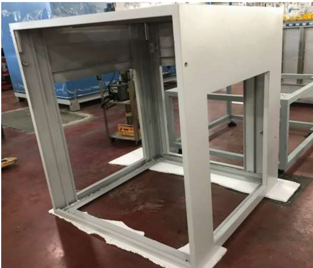
Figura 1 struttura esterna camera climatica
