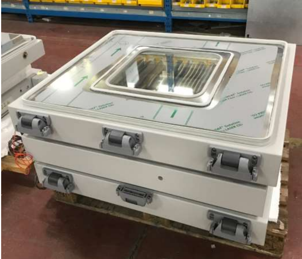
Figura 2 porte isolate camera climatica
