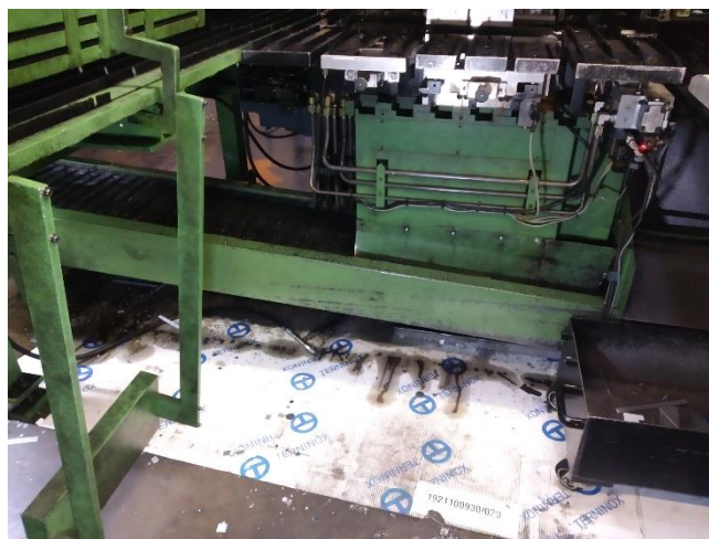
Fig 4.17 - Sporco residuo depositato sotto il nastro trasportatore (212H – S4)
