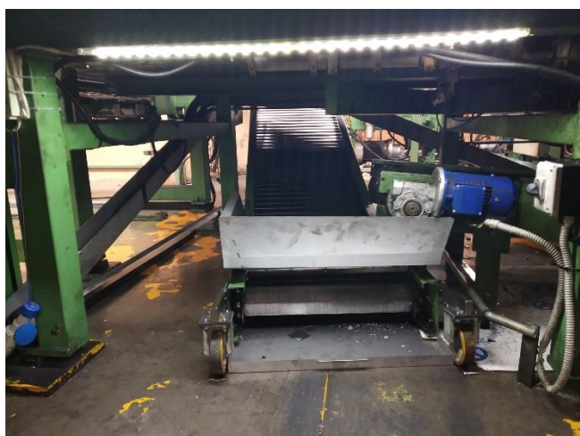
Fig 4.17 - Sporco residuo depositato sotto il nastro trasportatore (212H – S4)
