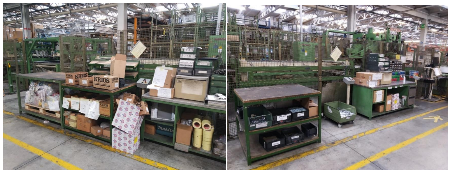
Fig 4.14 – immagine a sinistra è prima dell'applicazione della 2S, immagine a destra è dopo l'applicazione della 2S
