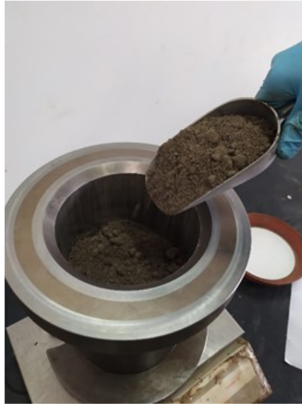
Figura 3.10 Inserimento del materiale nella fustella
