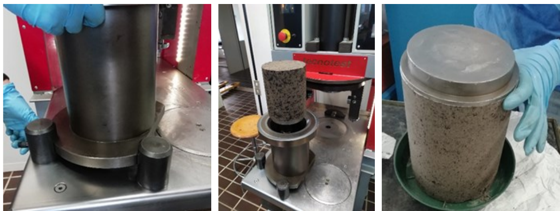
Figura 3.11 Estrazione del provino dalla fustella
