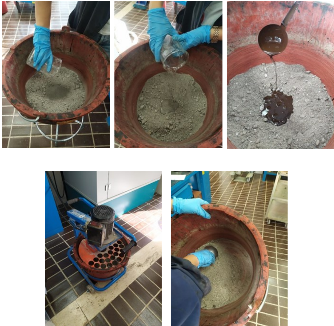
Figura 3.8 Fasi essenziali della miscelazione
