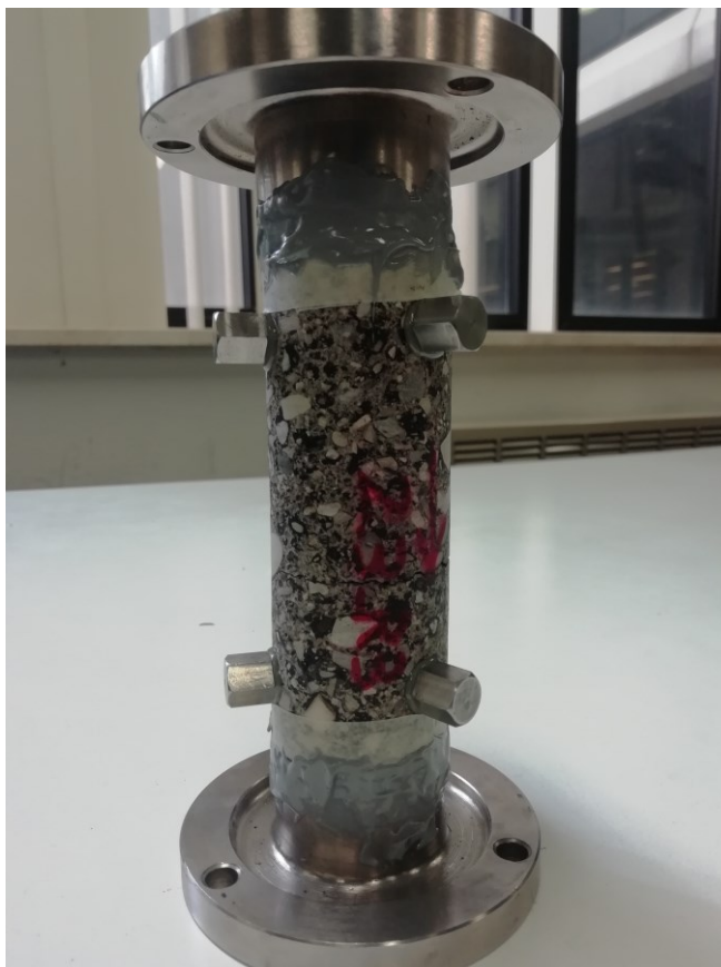
Figura 5.4 Provino 38_2.3_R3 incollato ai piatti di carico
