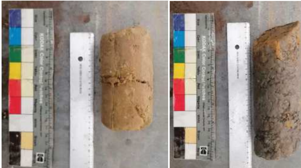
Figura 22: limo sabbioso consolidato (a sinistra) e campione di marna argillosa (a destra)
