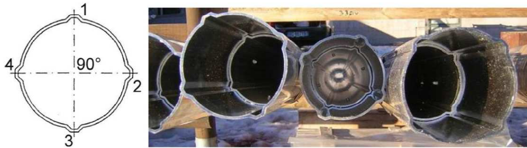
Figura 69: sezione tubo inclinometrico
