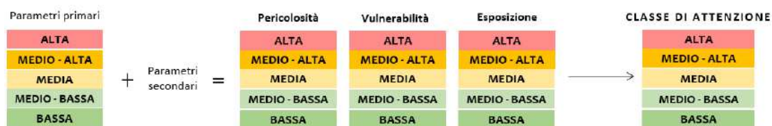
Figura 46: flusso logico per la determinazione della classe di attenzione sismica
