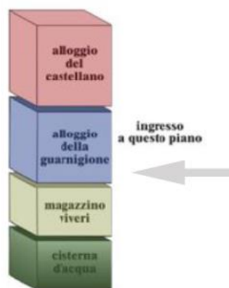
Figura 1.3 - Organizzazione interna Mastio. Fonte [4]
