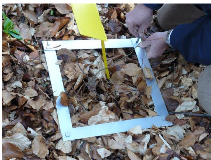
Fig. 15 – Cornice metallica 30 \times 30 \text{ cm} per il campionamento di lettiera ed orizzonti organici (fonte: Rodeghiero, 2013).
