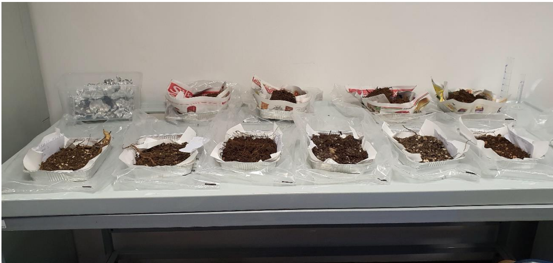
Fig. 21 – Essiccamento a temperatura ambiente dei campioni pedologici.
