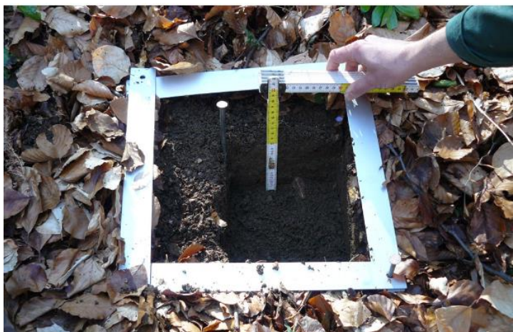
Fig. 16 – Raccolta degli orizzonti minerali in profili 20x20 cm di superficie e 30 cm di profondità (fonte: Rodeghiero, 2013).
