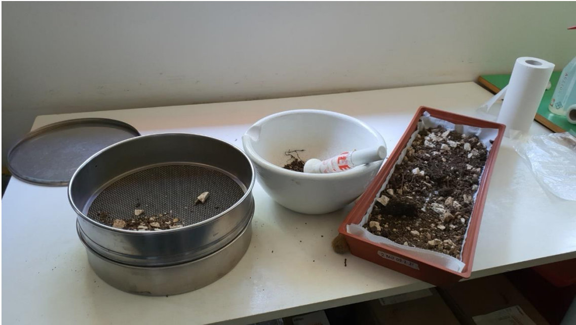
Fig. 22 – Frantumazione in mortaio e setacciatura a 2 mm del suolo minerale.
