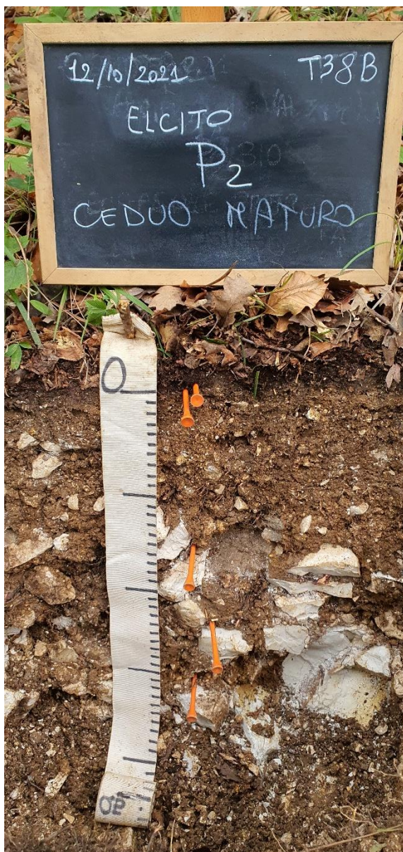
Fig. 20 – Apertura di un profilo pedologico per effettuare descrizioni e campionamenti del suolo.
