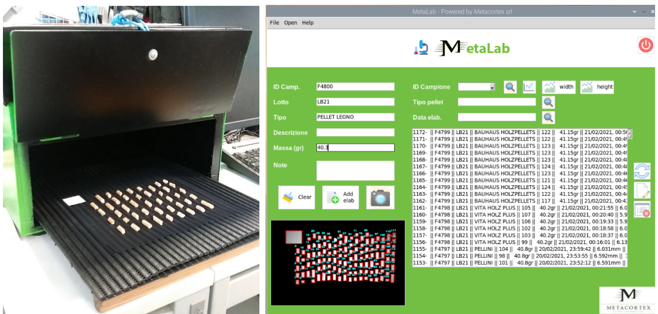
Figura 4 - A sinistra il box metallico contenente microcomputer, sensore IR e piatto estraibile; a destra il software di elaborazione MetaLab.
