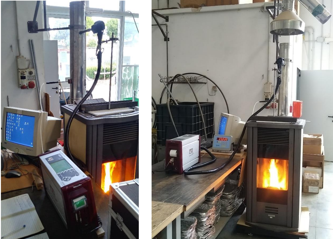
Figura 7 - Banco di lavoro durante le analisi delle emissioni con analizzatore MRU
