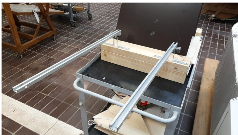
Figura 26. Vista della piastra anteriore con bracci di supporto specchi.
