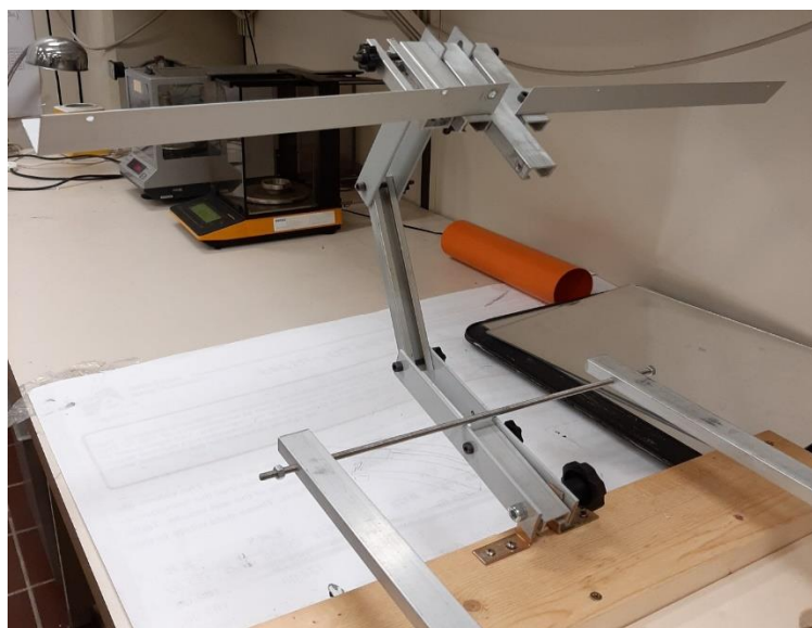
Figura 34. Braccio regolabile di supporto con sistema di fissaggio alla base.
