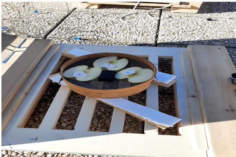
Figura 83. Sistema di supporto per gli spicchi di mela da essiccare.
