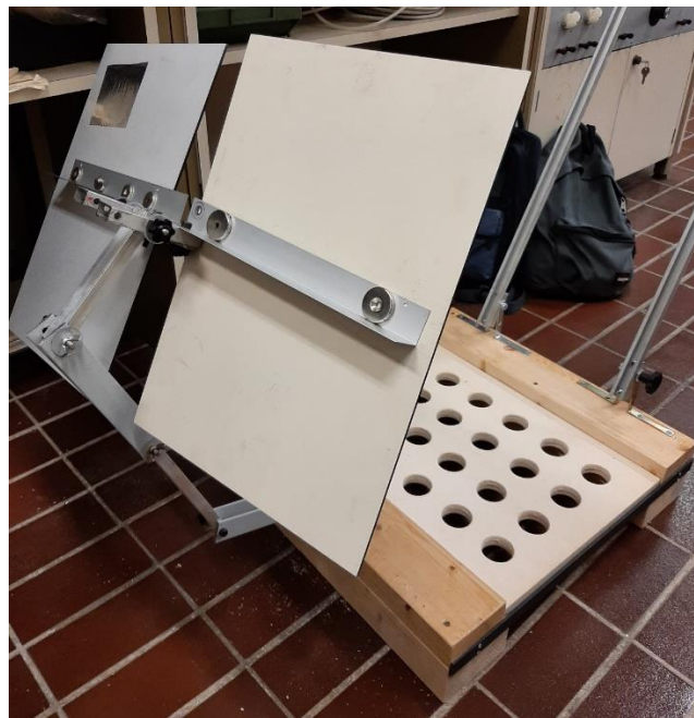
Figura 35. Sistema di bloccaggio degli specchi posteriori.
