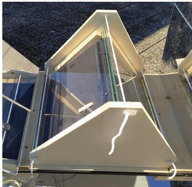
Figura 30. Vista esterna della camera di essiccazione composta da piastre e sportelli laterali.
