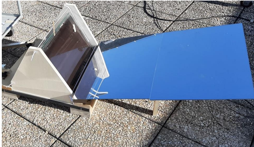
Figura 33. Sistema a due specchi anteriori di riflessione.
