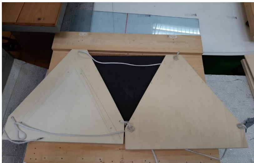
Figura 27. Vista degli sportelli con relativo sistema di blocco.
