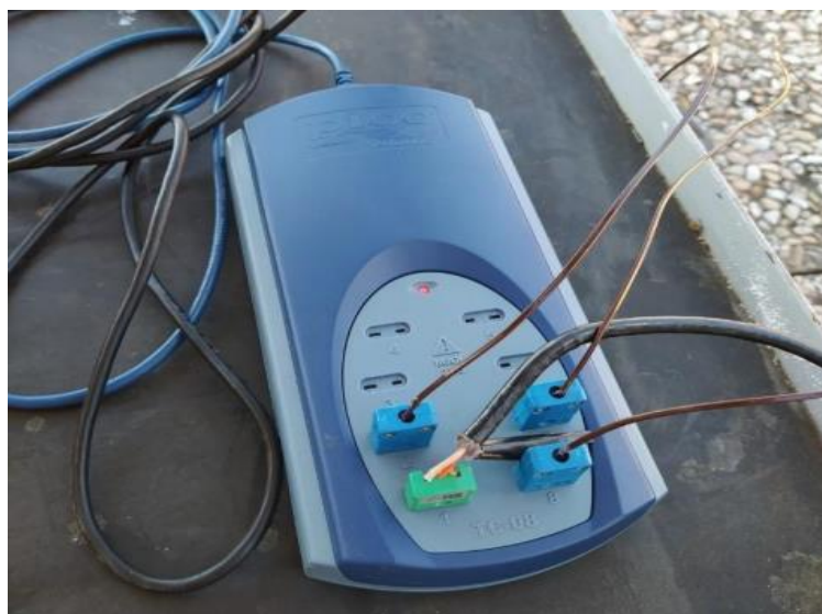
Figura 43. Acquisitore con connettori inseriti.
