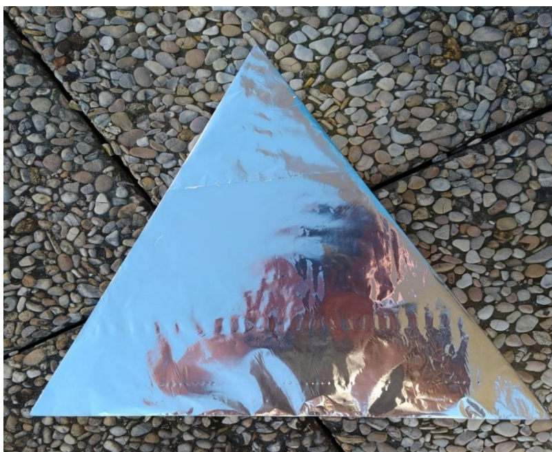
Figura 15. Sportelli laterali triangolari rivestiti dallo strato di alluminio.
