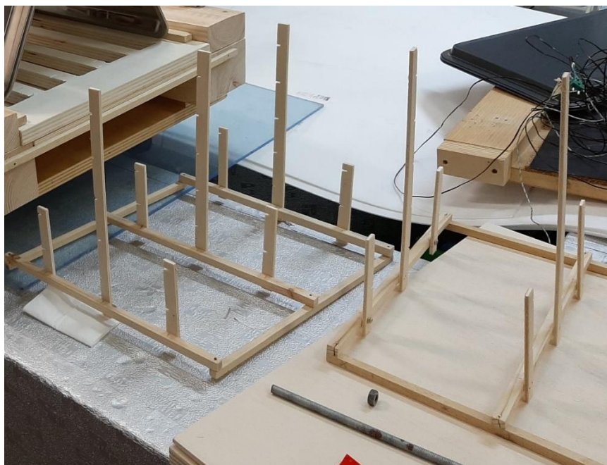
Figura 40. Supporto in legno per la misurazione di temperatura a più livelli di altezza.
