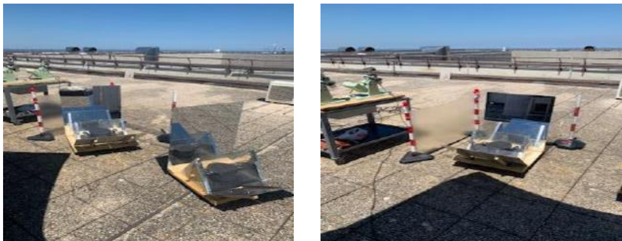
Figura 46 e 47. Sistema di schermatura dei forni.
