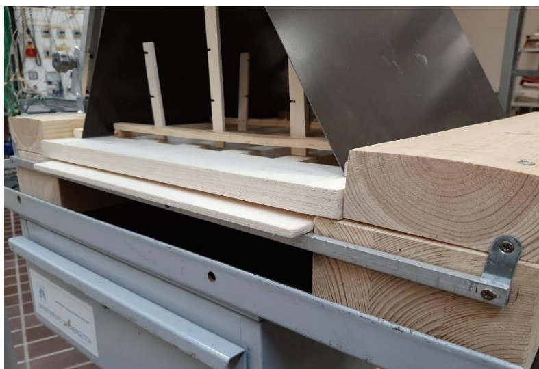
Figura 21. Vista frontale dell'essiccatore con trave di supporto in alluminio e lastra di controllo del flusso d'aria.
