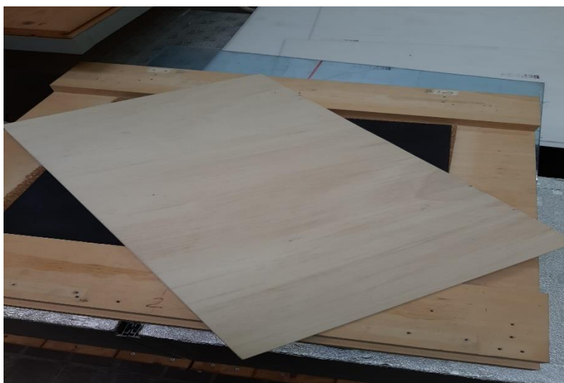
Figura 24. Sistema di supporto munito di lastra regolatrice sotto la base.
