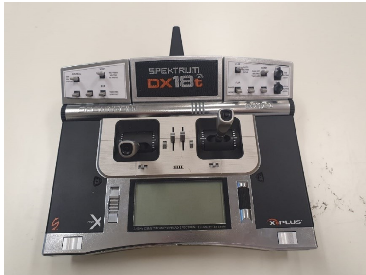
Figura 1-10: radiocomando per la gestione da terra del sistema di acquisizione delle immagini
