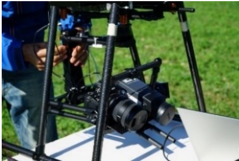
Figura 1-8: dettaglio del sistema di acquisizione delle immagini
