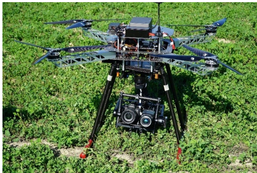
Figura 1-9: drone quadricottero equipaggiato con il sistema di acquisizione delle immagini
