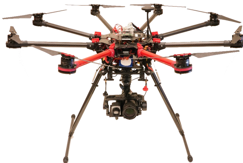
Figura 1-14: drone ottacottero equipaggiato con il sistema di acquisizione delle immagini
