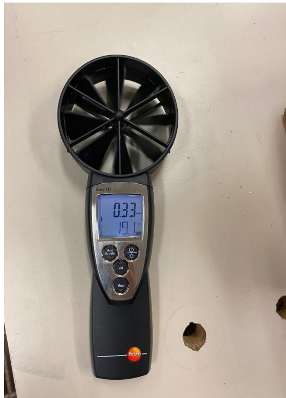
Figura 32 – Anemometro con il quale man mano che la portata aumenta consente di leggere i valori corrispondenti alla variazione di alimentazione del variac
