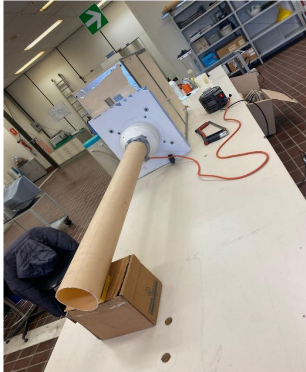
Figura 33 – Tubo in pvc attaccato alla ventola usato per la misurazione
