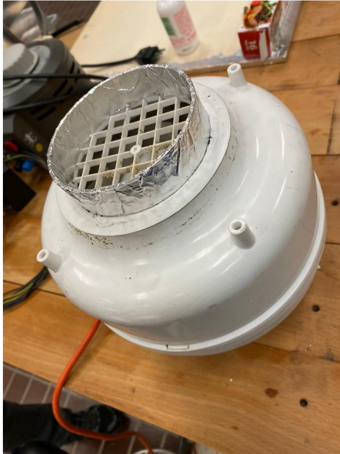
Figura 26 – Ventola assiale usata nel nuovo sistema che garantisce una portata minore
