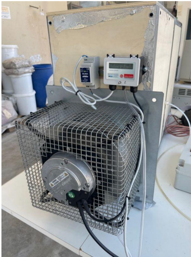
Figura 24 – Ventola radiale avvolta dalla gabbia protettiva. La ventola radiale garantisce una portata minima di 70 \text{ m}^3/\text{h} potendo arrivare ad una portata massima di 184 \text{ m}^3/\text{h} e può essere regolata con un sistema incorporato alla ventola.
