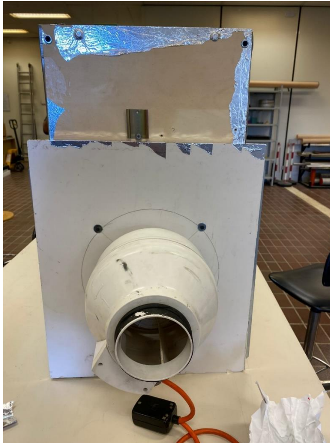
Figure 29 e 30 – Ventola assiale inserita nel nuovo sistema
