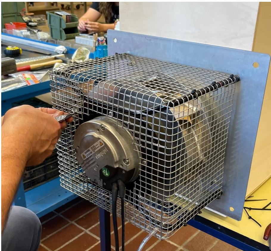
Figura 8 - Ventola ad aspirazione alla fine del box
