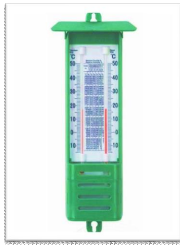
Figura 2 Esempio di uno psicrometro utilizzato per misurare l'umidità
