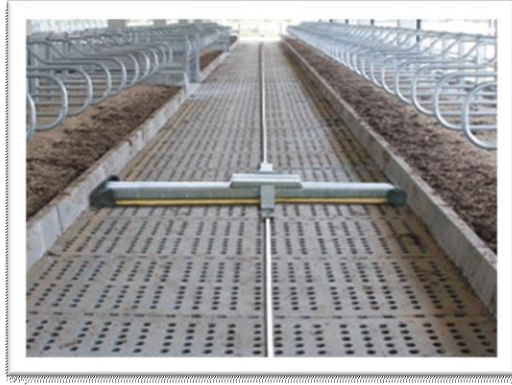
Figura 20 Raschiatore per la rimozione dei liquami
