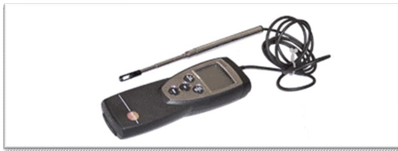
Figura 3 Esempio di un anemometro a filo caldo
