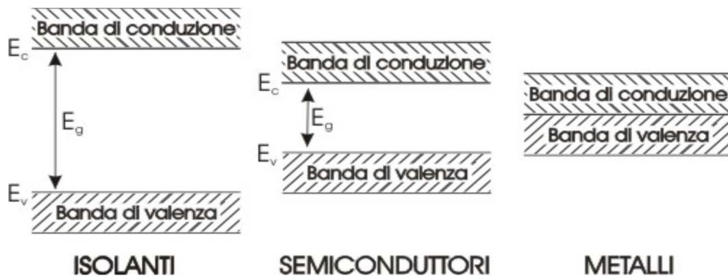
Figura 2.7. Materiali isolanti, semiconduttori e conduttori in relazione al gap energetico (Fonte: https://www.antoniosantoro.com )
