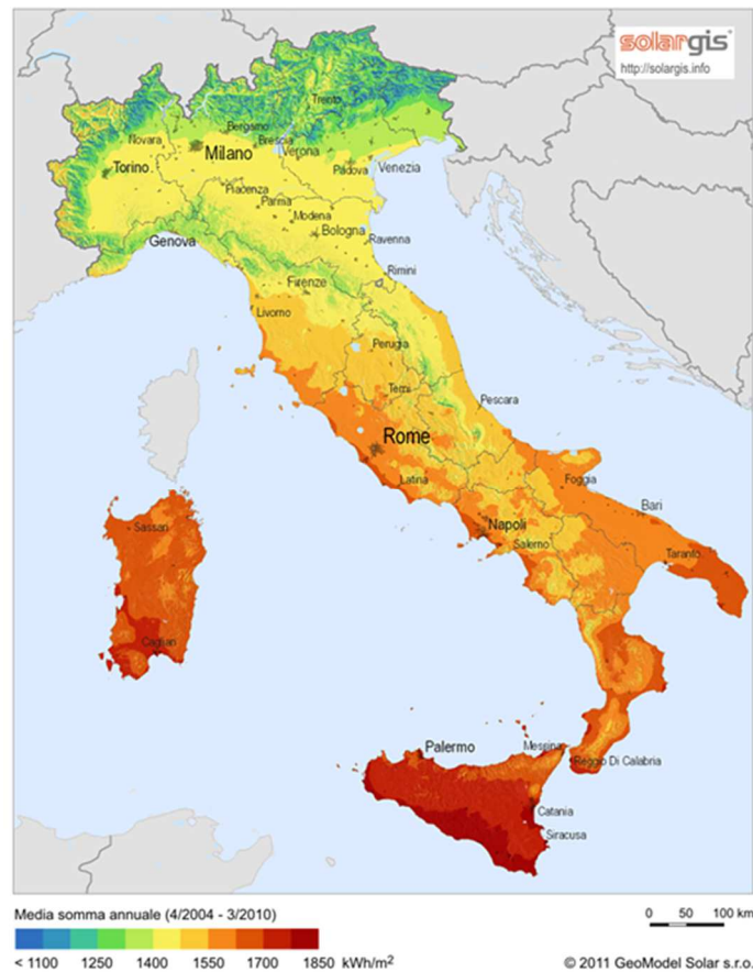
Figura 2.4: Irraggiamento medio annuale sul piano orizzontale H_h (Fonte: https://www.solargis.it )
