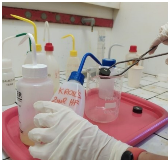
Figura 4.2.4 , Esecuzione dell'attacco chimico
