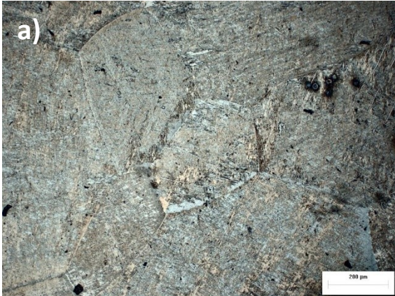
Figura 4.3.2 (a) , Microstruttura della lega Ti-6Al-4V, 10x08
