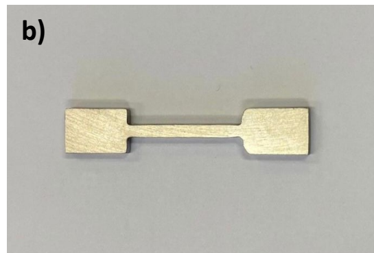
Figura 4.1.1 (b) , Foto di un campione lucidato
