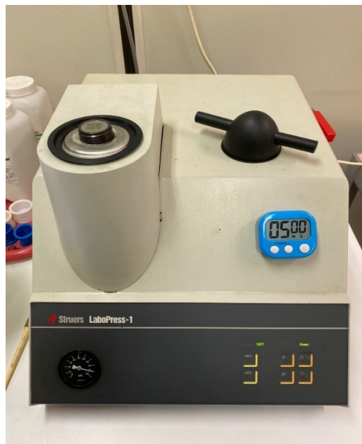
Figura 4.2.1 , Foto di una pressa per l'inglobatura
