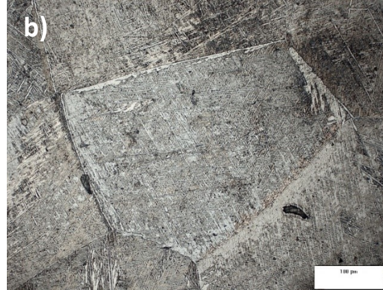
Figura 4.3.2 (b) , Microstruttura della lega Ti-6Al-4V, 20x08
