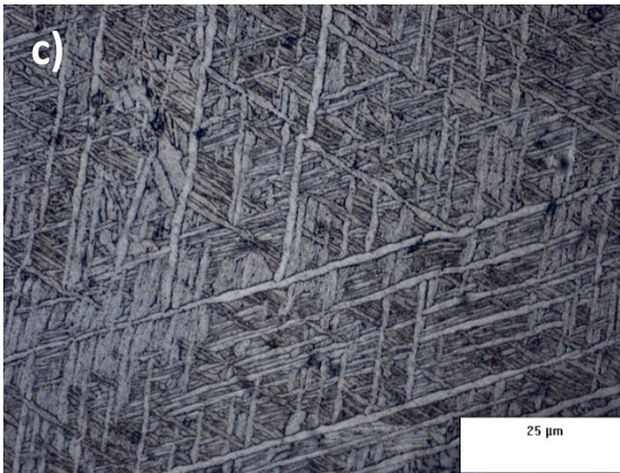
Figura 4.3.2 (c) , Microstruttura della lega Ti-6Al-4V, 50x1
