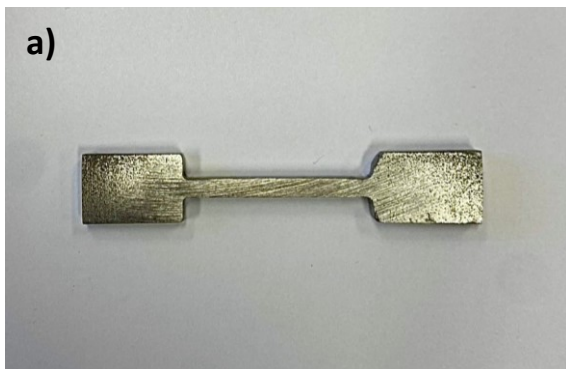
Figura 4.1.1 (a) , Foto di un campione proveniente da additive manufacturing non lucidato
