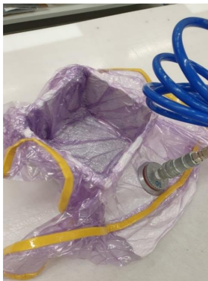
Figura 4-3 Provino all'interno del sacco da vuoto prima di essere inserito all'interno dell'autoclave
