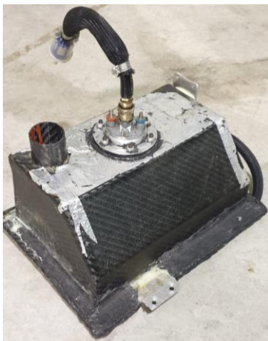
Figura 3-4 Serbatoio precedente, visto dall'alto
