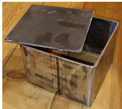
Figura 4-4 Stampo provino dopo l’estrazione del provino
