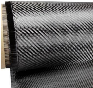
Figura 2-1 Tessuto in fibra di carbonio “Twill” 2/2 con fibre disposte a 0/90°
