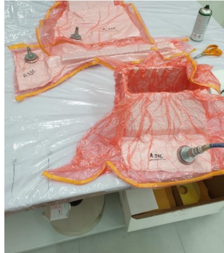
Figura 6-3 Serbatoio nel sacco da vuoto
