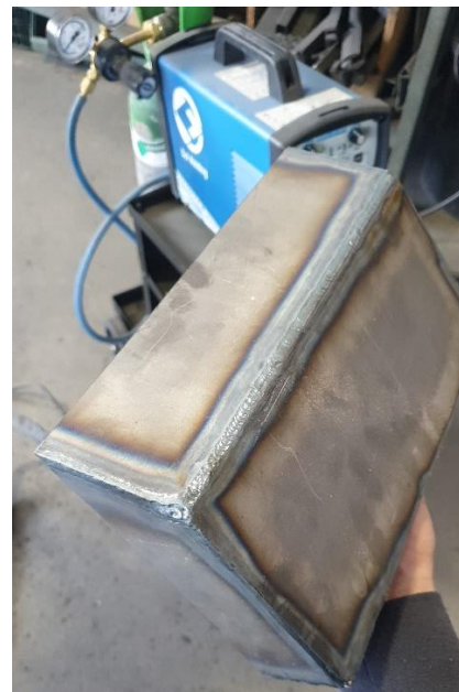
Figura 5-15 Coperchio in fase di realizzazione e saldatrice TIG nello sfondo
