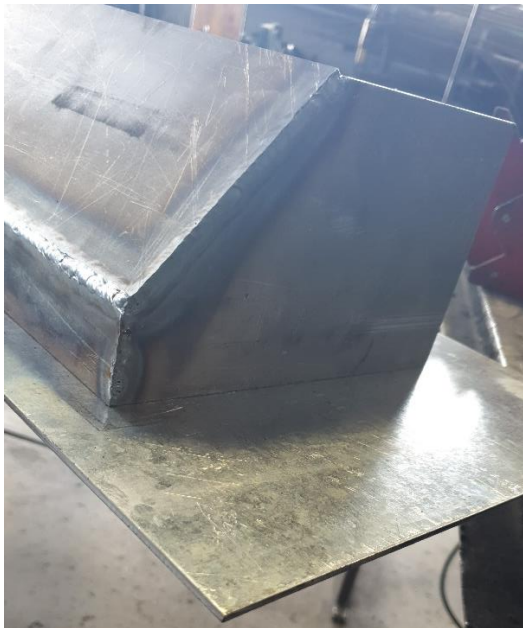
Figura 5-14 Semi-metà dello stampo in fase di realizzazione
