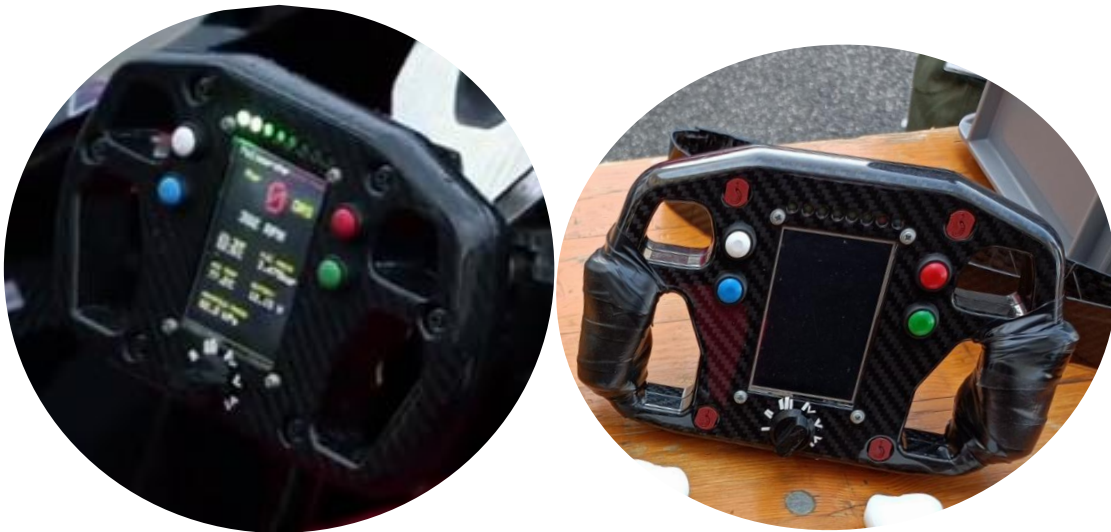
Figura 34: comparazione volante in funzione senza impugnature e in configurazione finale con le impugnature
