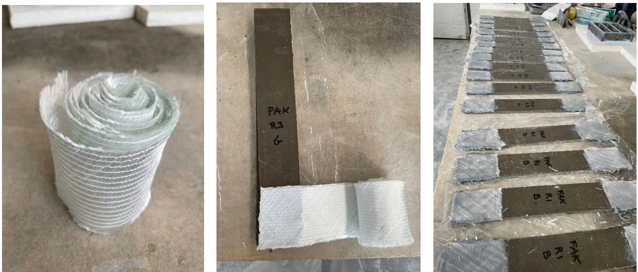
Fig. 67 - Incollaggio delle fasce in fibra di vetro
