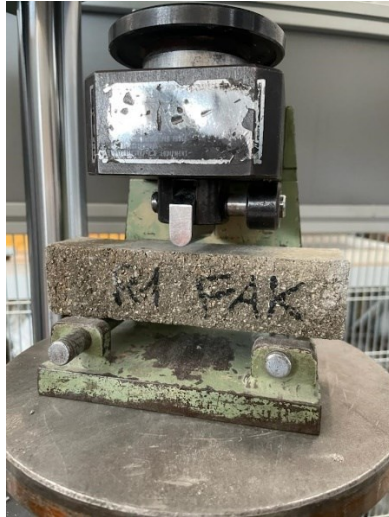
Fig. 58 - Prova di resistenza a flessione
