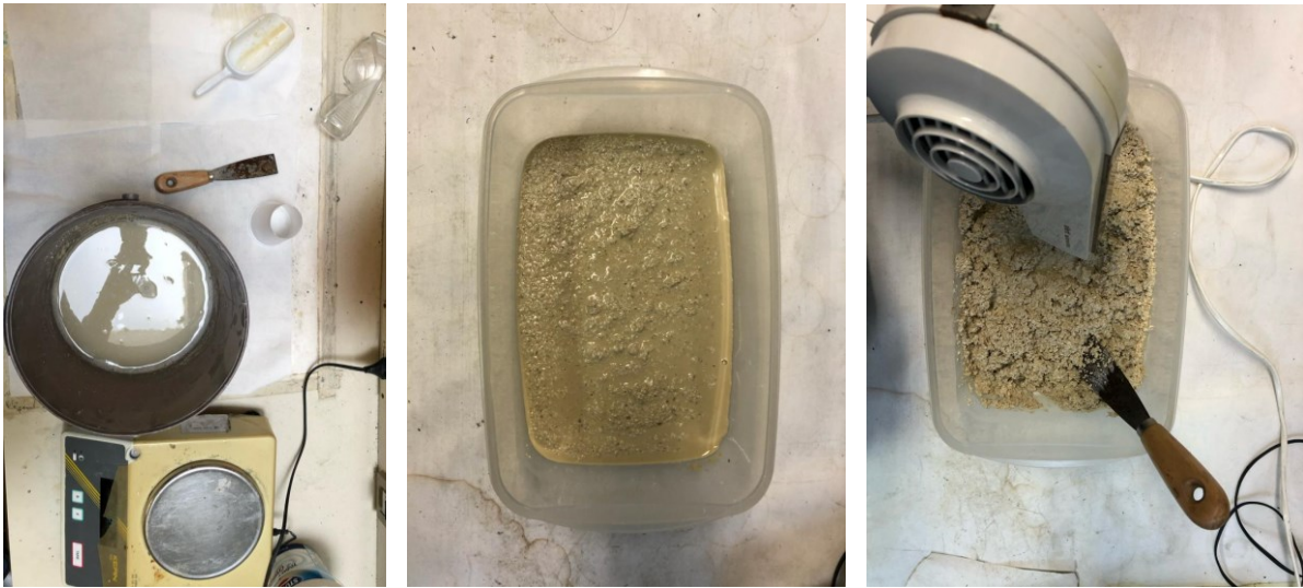
Fig. 42 - Fasi della verifica dell'assorbimento dell'acqua
