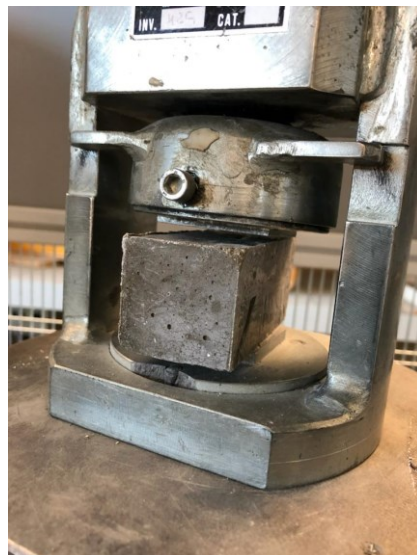
Fig. 59 - Prova di resistenza a compressione
