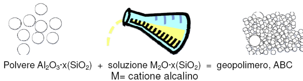
Fig. 4 - Materie prime nella produzione del materiale geopolimerico
