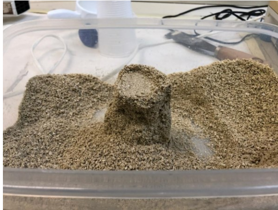
Fig. 44 - Condizione di s.s.a. dell'inerte utilizzato
