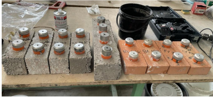
Fig. 62 - Dolly incollati ai vari supporti
