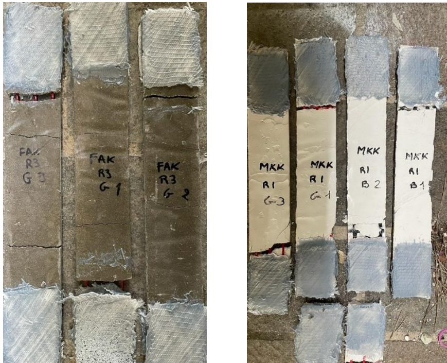
Fig. 66 - Provini fessurati a trazione
