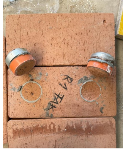
Fig. 64 - Due tipologie di distacco: in ordine distacco tipo A e C
