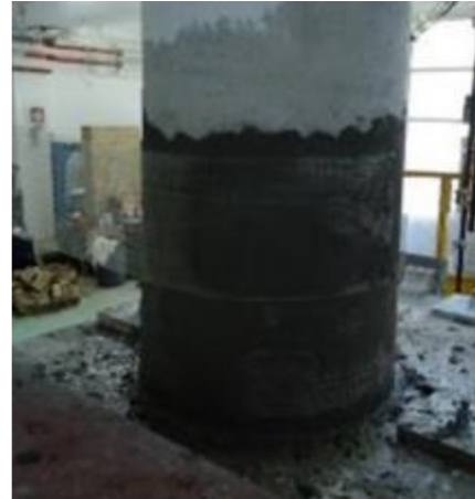
Fig. 15 - Rinforzo a flessione di trave mediante placcaggio con strisce di tessuto unidirezionale realizzate con rete di acciaio e malta cementizia (a sinistra); Confinamento di pilastro con tessuto metallico unidirezionale e malta (a destra)
