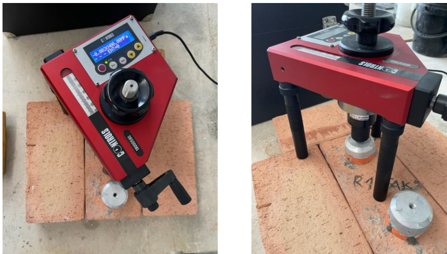
Fig. 63 - Prova di pull-off
