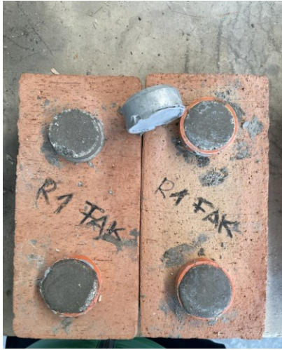
Fig. 64 - Due tipologie di distacco: in ordine distacco tipo A e C
