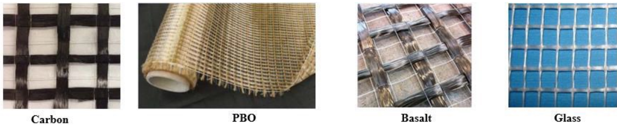
Fig. 27 - Tipologie di fibre impiegate nella realizzazione dei materiali compositi
