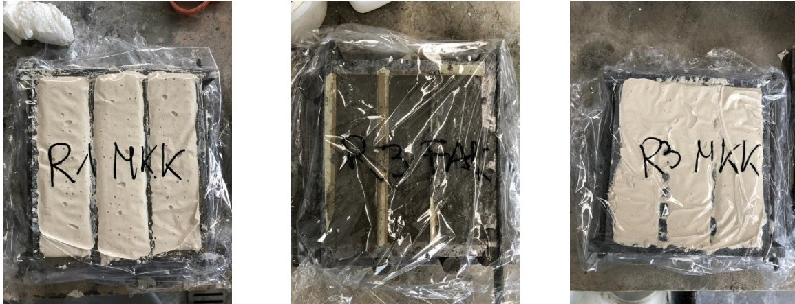
Fig. 53 - Provini gettati sui casseri in ferro
