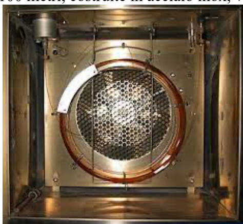
Figura 1-5 Struttura forno del gascromatografo con all'interno la colonna.
