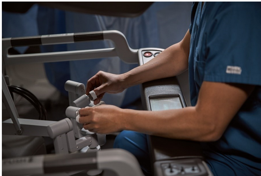
Figura 4.9: master controllers e supporto gomiti con pannelli di controllo [47]
