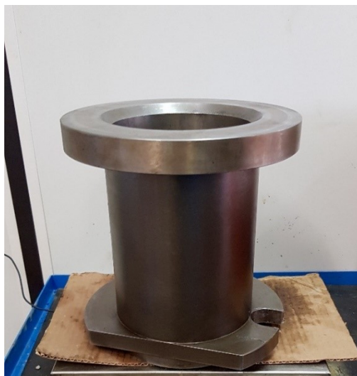
Figura 4.26 - Fustella con diametro 150 mm
