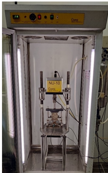
Figura 4.40 - Cella di carico del NAT con al di sotto il castelletto contenente il provino
