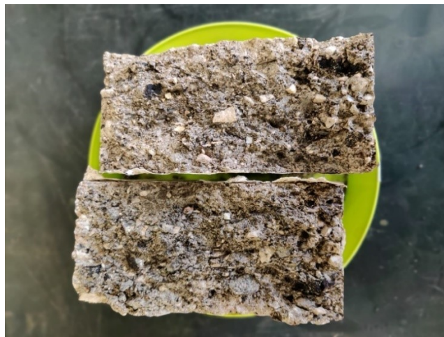
Figura 4.53 - Provino rotto a seguito della prova a trazione indiretta
