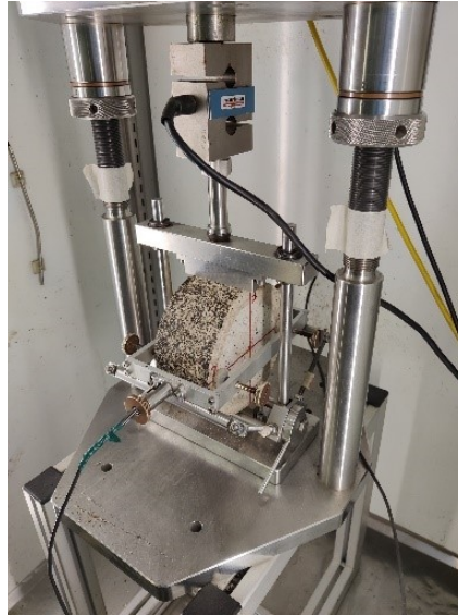
Figura 4.39 - Provino posizionato nella macchina e trasduttori montati
