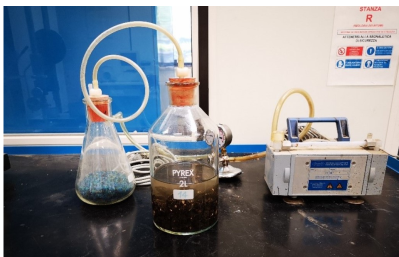
Figura 4.5 - Picnometro collegato alla pompa per sottovuoto
