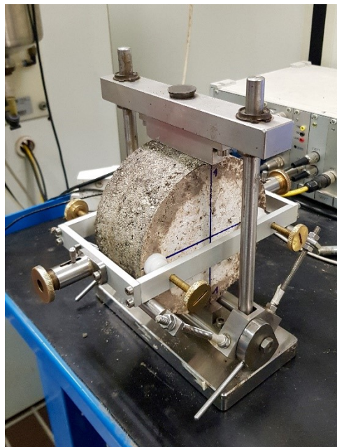
Figura 4.38 - Provino montato sul castelletto e testa di carico applicata
