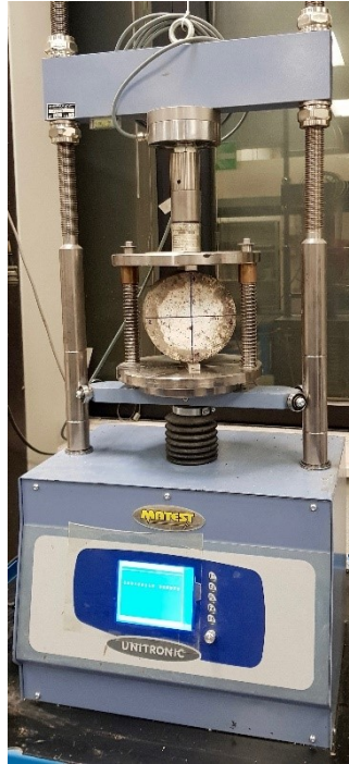
Figura 4.49 - Posizionamento del provino tra i piatti della pressa
