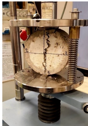
Figura 4.50 - Provino rotto dopo la prova
