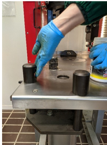
Figura 4.28 - Lubrificazione del piano di appoggio
