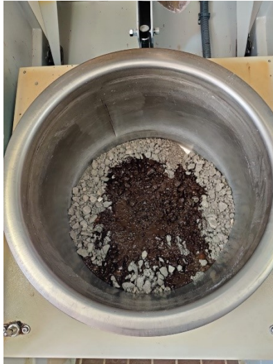
Figura 4.18 - Aggiunta dell'emulsione bituminosa nel miscelatore
