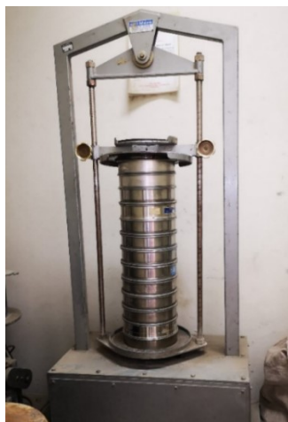
Figura 4.2 - Pila di setacci posizionata nel vibro-vaglio
