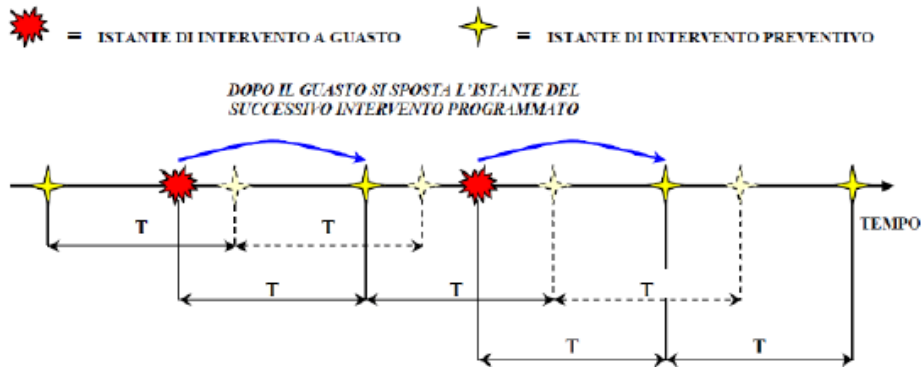
Figura 3.5.2.2 - Manutenzione preventiva ciclica ad età costante nel tempo a calendario di un'entità
