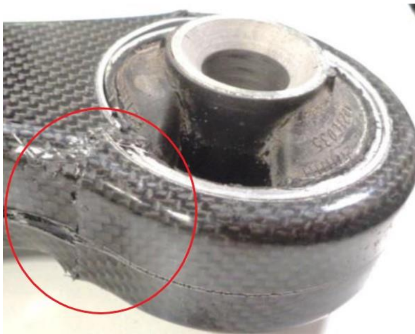
Figura 64. Rottura R2 zona punto 2
