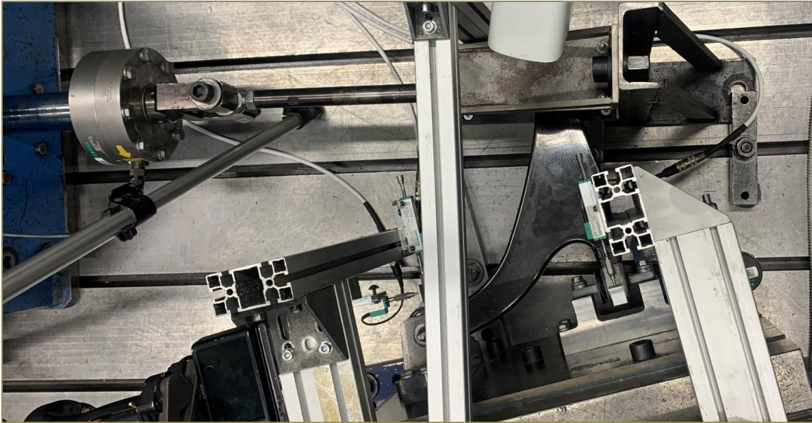
Figura 206. Leva sospensione posizionata su banco di prova
