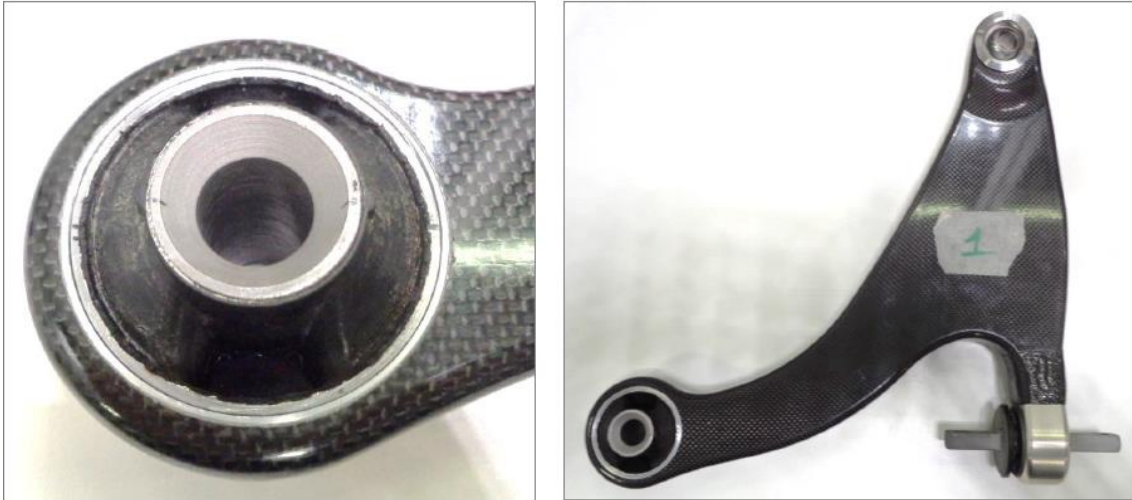
Figura 23. Leva dopo piantaggio dei bushing e dettaglio del punto 2
