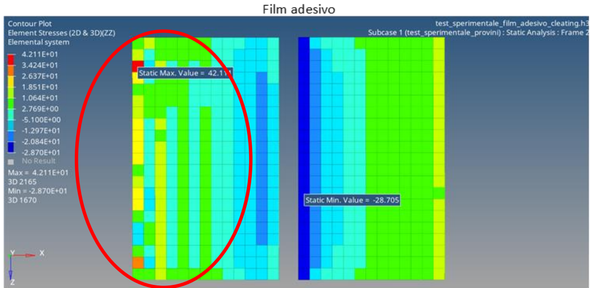
Figura 183. Distribuzione della tensione nel provino di AF163-2K
