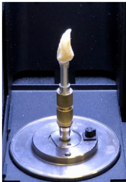
Figura 17: Campione posizionato sul supporto interno della \mu\text{CT} . Fonte: Giuliani et al. 2018.
