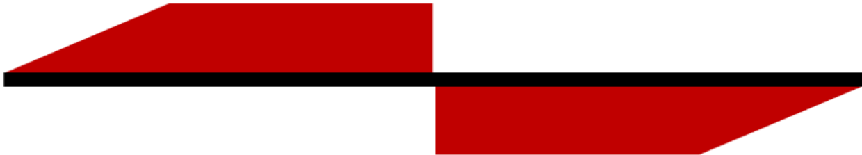
Figura 4.3 Diagrammi di momento flettente su bilanciere
